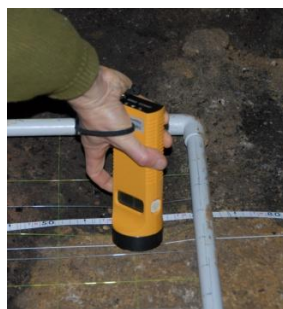
Figure 20 : Susceptibilimètre KT-9 (Exploranium). © cliché : A. Burens.
