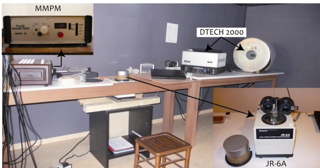
Figure 24 : Chambre à champ magnétique atténué où sont effectuées les mesures d'aimantation à l'aide du magnétomètre spinner JR-6A (AGICO), les impulsions de champ magnétique (MMPM 10) et les désaimantations en champ alternatif (DTECH 2000).
