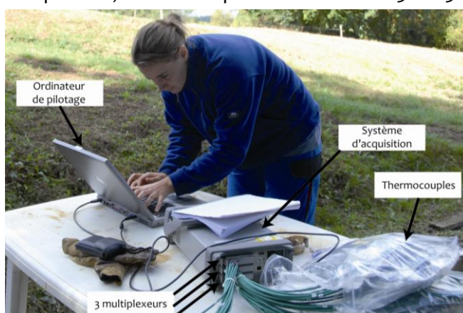
Figure 189 : Dispositif d'enregistrement des températures : 60 thermocouples (type K), reliés à 3 multiplexeurs connectés à un système d'acquisition (34972A, Aquitek) piloté en externe par le logiciel « BenchLink Data Logger ».
