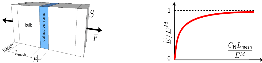
FIGURE 1.10 – Illustration de la relation entre le module de Young apparent et la taille de maillage dans le cas unidimensionnel : à gauche, une partie représentative d’une discrétisation éléments finis 1-D avec une zone cohésive insérée entre deux éléments, à droite, le module de Young apparent normé en fonction de la taille du maillage.
