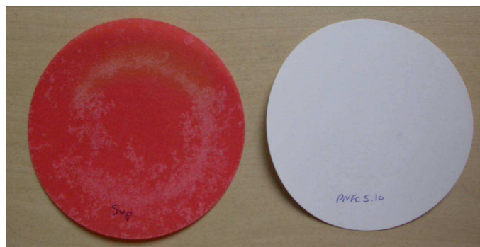
Figure 26 : Résistance à la graisse des couches PVA L /MFC.
