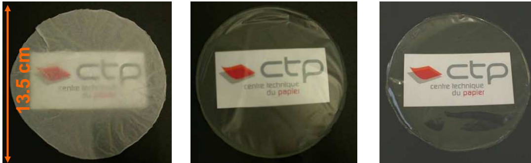
Figure 11 : Apparences des films obtenues à partir de MFC-Arbo, MFC-E-MG, MFC-T-MG.
