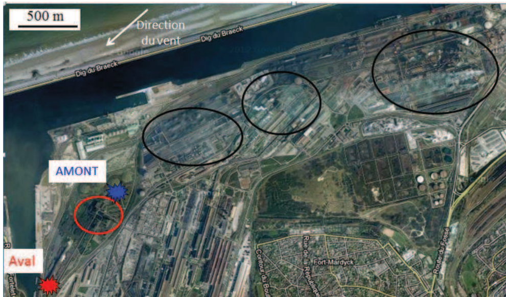
Figure 56 : Carte de la zone d'étude (Google Earth) : localisation du site industriel étudié (cercle rouge), des sites de mesures Amont (bleu) et Aval (rouge) et localisation des sources canalisées avoisinantes (cercles noirs)
