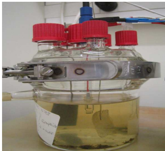
Figure 28: Photos du montage expérimental. A) montage simple à 3 électrodes, B) montage avec dispositif N-STAT.
