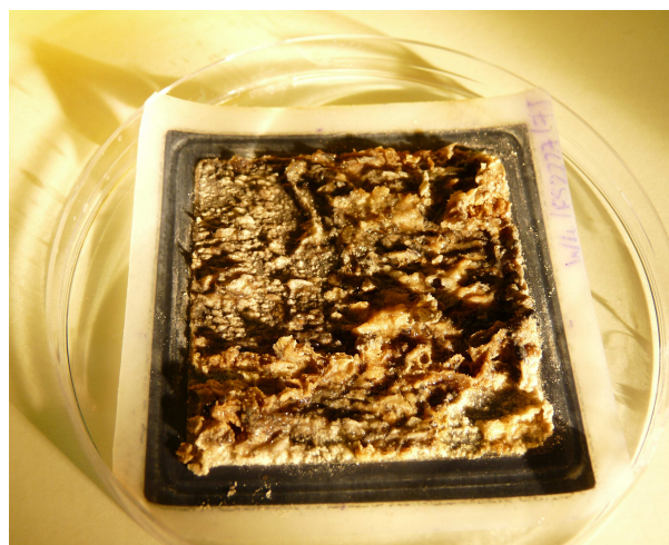
Figure 93: Photos représentant l'état d'encrassement de la cathode après 24h (A) et 45 jours (B) d'alimentation en continu de la pile avec l'effluent sortie méthaniseur brut. Photos réalisées au LGC.
