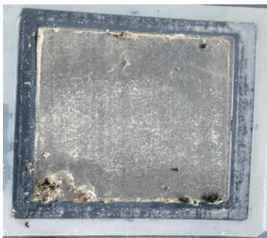
Figure 93: Photos représentant l'état d'encrassement de la cathode après 24h (A) et 45 jours (B) d'alimentation en continu de la pile avec l'effluent sortie méthaniseur brut. Photos réalisées au LGC.
