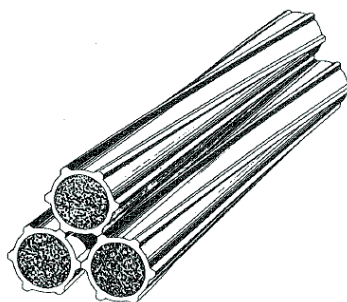
FIG. 1.7: Schéma de crayons en réseau hexagonal avec gaines cannelées de fils espaceurs [Cornelis et al., 1985]
