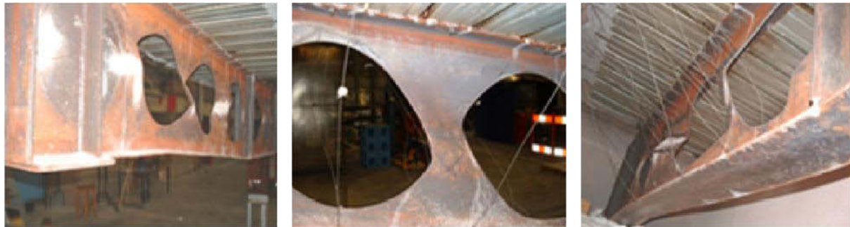
Figure I-13 Ruine par flambement du montant lors d'essais à hautes températures [NAD, 07]
