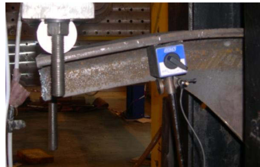
Figure V-1 Exemple des deux modèles avec ruine par formation de rotule plastique (poutre globale à gauche et montant isolé à droite)
