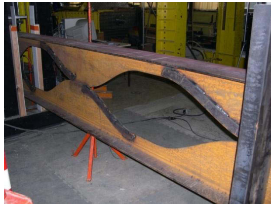
Figure II-10 Photographie prise après raidissage des ouvertures 5 et 6 de la poutre AS012
