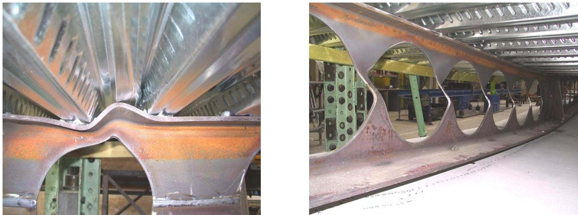
Figure I-12 Modes de ruine de poutres mixtes cellulaires avec une ruine par flexion Vierendeel (gauche) flambement du montant (droite)
