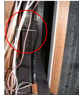
(b) Observation de l'onde de voilement au niveau du capteur H07
