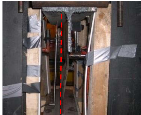
Figure III-11 Ruine de l'échantillon C-2 avec flambement global de l'échantillon
