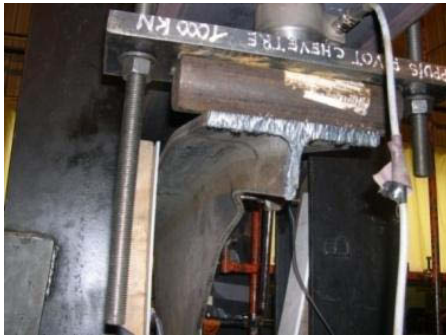
Figure III-7 Comparaison entre les déformées ultimes obtenues expérimentalement et numériquement (échantillon B)
