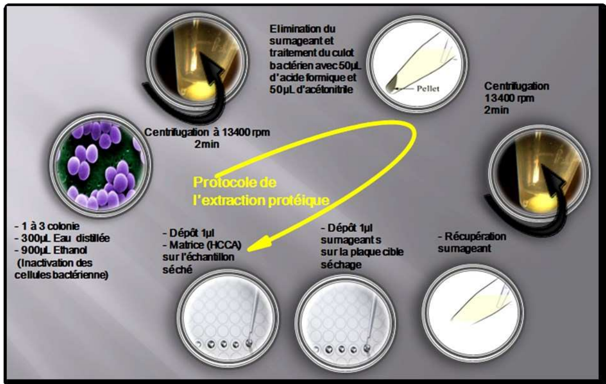
Figure 18: Les différentes étapes de l'extraction protéique pour une éventuelle identification par MALDI-TOF/MS
