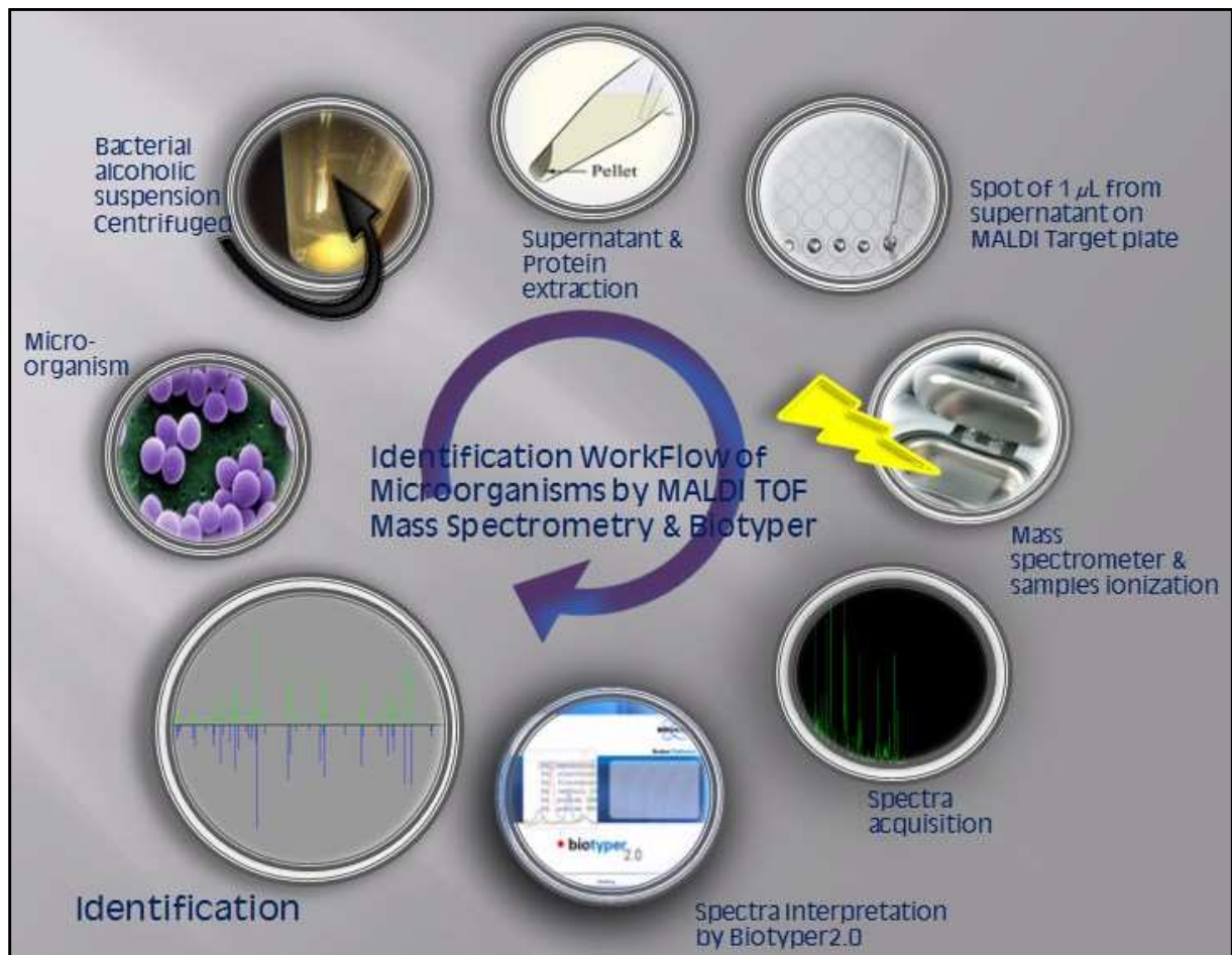
Figure 12 :Workflow (Schéma général) de l'identification bactérienne par MALDI-TOF/MS
