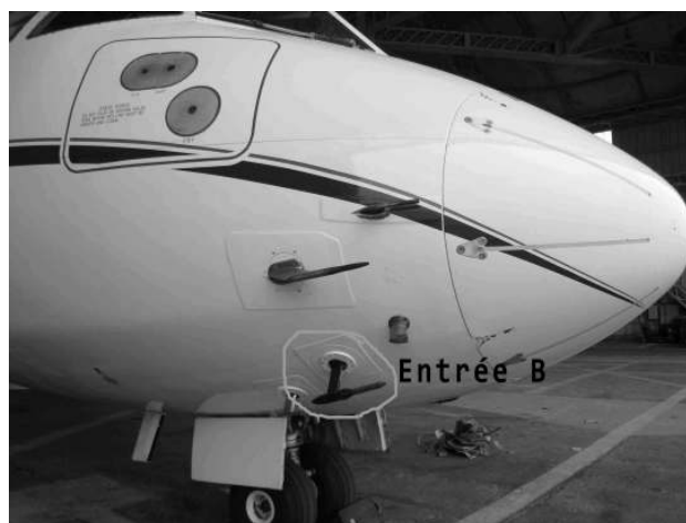
Figure 14. Emplacement de l'entrée B
