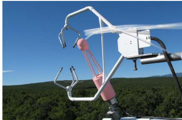
FIGURE 2.8 – Exemple de dispositif expérimental pour la technique EC comprenant un anémomètre sonique, un analyseur de \text{CO}_2 et \text{H}_2\text{O} (rouge pâle) et plusieurs tubes de prélèvements.
