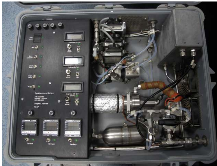
FIGURE 6.9 – Photo du FIS en version originale (FIS-97).
