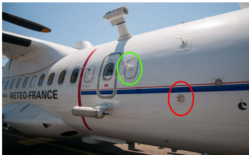
FIGURE 5.17 – Vue de la partie droite du fuselage de l'ATR-42 avec entourée en rouge la position de la prise d'air de MEDEE et en vert la position du capteur LI-7500.
