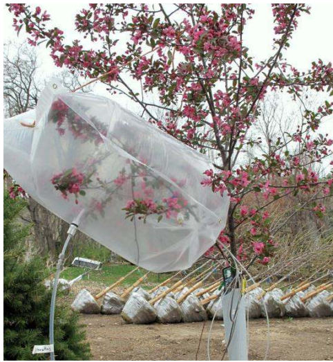
FIGURE 2.6 – Photo d'une chambre en Teflon sur une branche de pommier d'ornement ( Malus sp. ) lors d'une étude sur les émissions de COV des fleurs (Baghi et al., 2012a).
