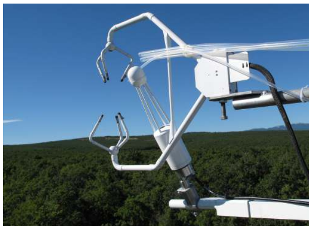
FIGURE 6.6 – Dispositif expérimental pour la technique EC comprenant un anémomètre sonique, un analyseur de CO_2 et H_2O et plusieurs tubes de prélèvements.
