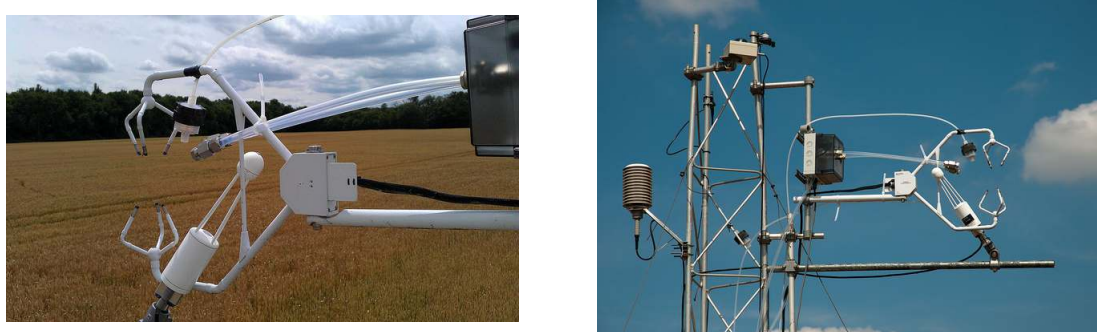
FIGURE 5.2 – Mât de mesures sur le site de Lamasquère avec l'anémomètre sonique, l'analyseur de \text{CO}_2 et \text{H}_2\text{O} (LI-7500) ainsi que le boîtier des électrovannes de prélèvement de MEDEE et les lignes de prise d'échantillon.
