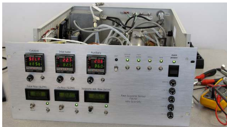
FIGURE 6.11 – Photo de la face avant du FIS remis en état et adapté dans un rack 19".
