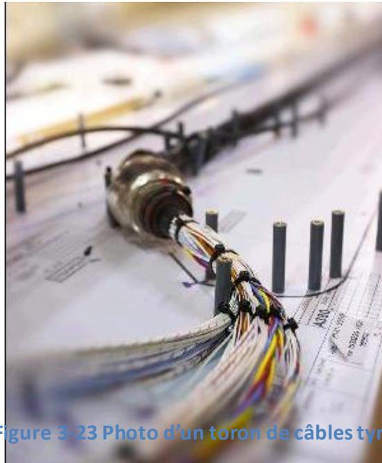
**Figure 3-23 Photo d'un toron de câbles tyrapé**
