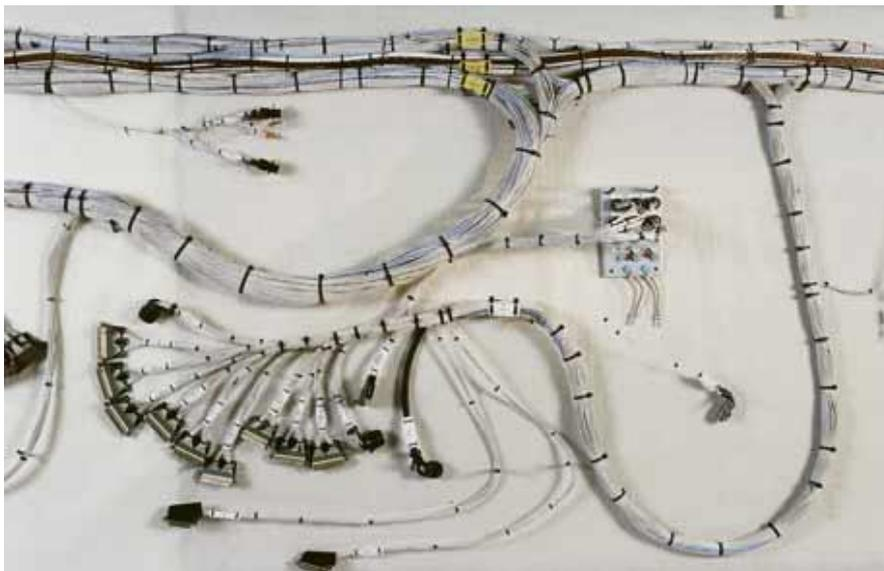
**Figure 2-14 Photo d'un harnais fini d'un A380**
