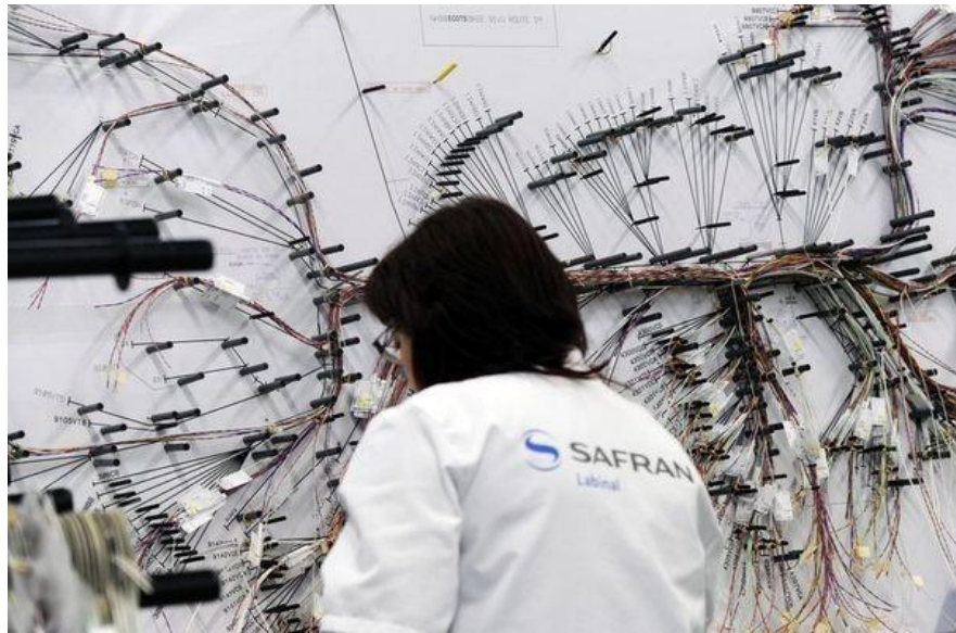
Figure 2-13 Photo d'une opératrice montant un harnais
