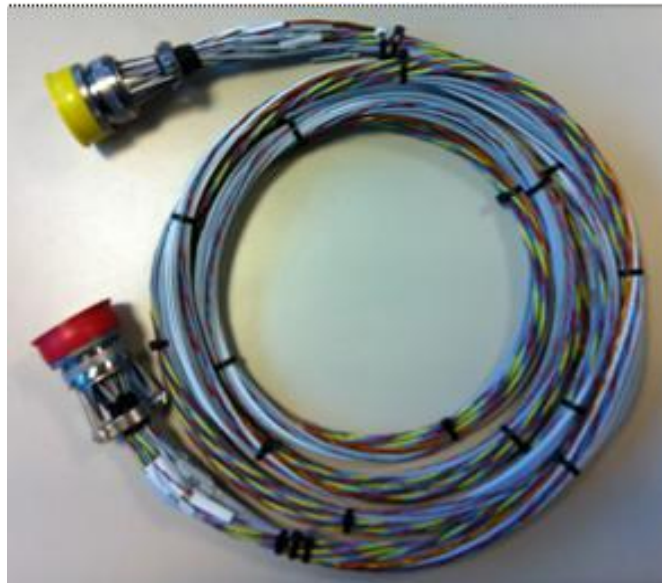
Figure 5-14 Photo du toron complexe, composé de 59 câbles élémentaires
