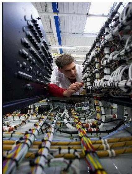
**Figure 1-7 Montage des harnais dans un meuble électrique**
