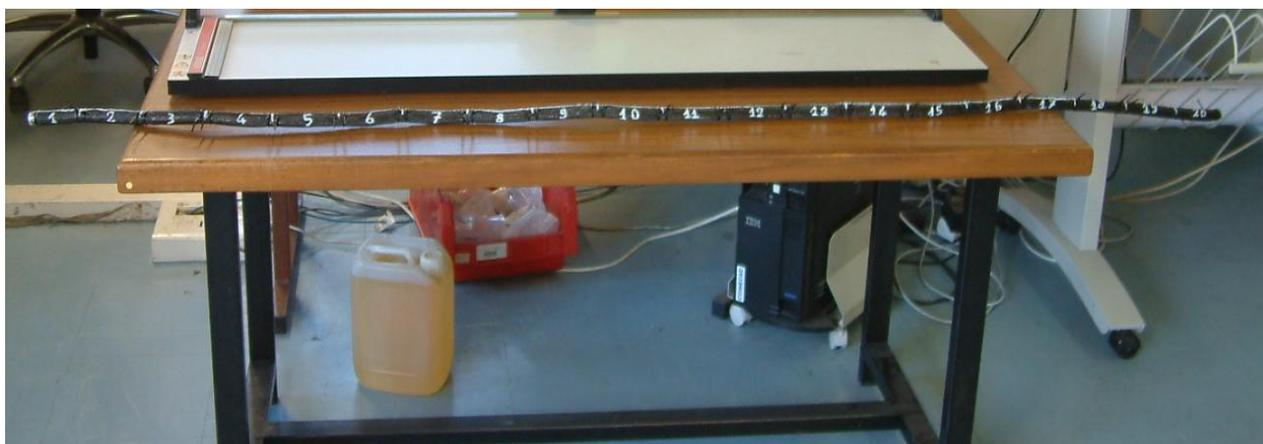
Figure 3-33 Photo de l'échantillon prélevé du toron
