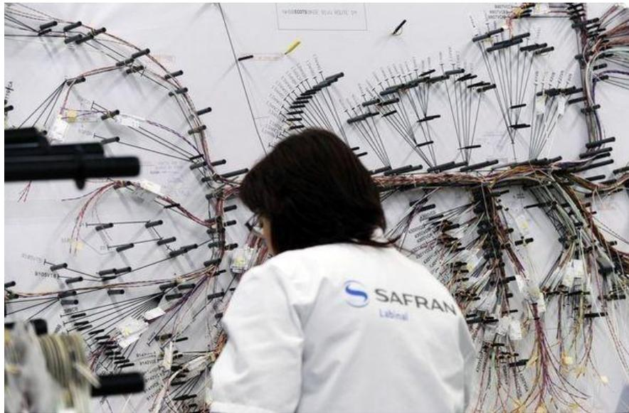
**Figure 2-13 Photo d'une opératrice montant un harnais**
