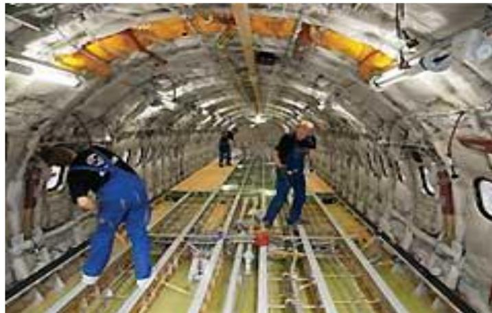
Figure 1-8 Installation de harnais dans un fuselage
