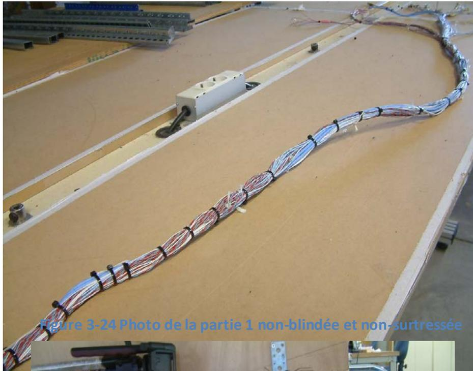
Figure 3-24 Photo de la partie 1 non-blindée et non-surtressée
