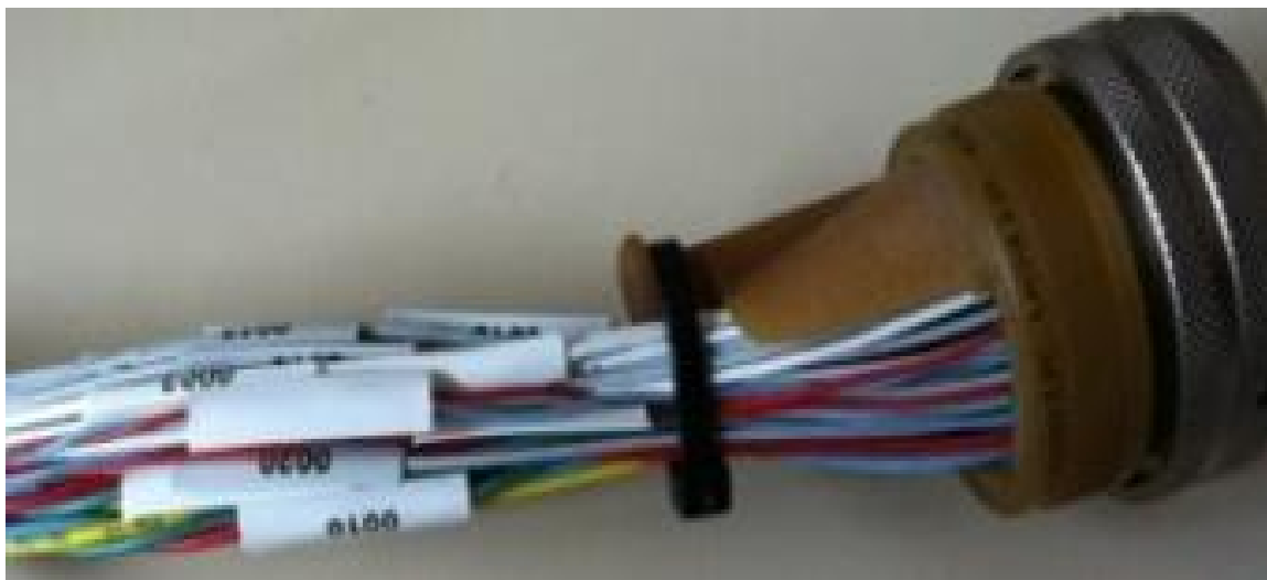
Figure 4-3 Photo d'une extrémité d'un harnais de câble avec un détorsadage des câbles
