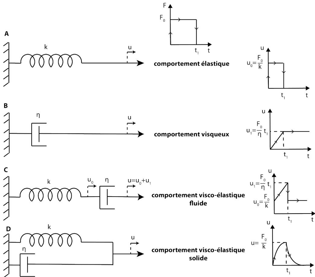
FIGURE 1.4.2: Les modèles équivalents en une dimension avec leur réponse à une sollicitation.
