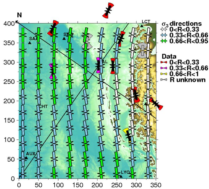
**FIGURE 3.3.1:** Directions de la contrainte principale minimale à 15 km. Les conditions aux limites sont des conditions en contrainte avec une contrainte proportionnelle au poids des terrains appliquée dans la direction normale aux bords. Cette conditions aux limites est l'équivalent en contraintes de la condition de non déplacement. De plus une contrainte homogène est appliquée dans la direction X. Voir figure 3.2.1 pour une description détaillée de la figure.
