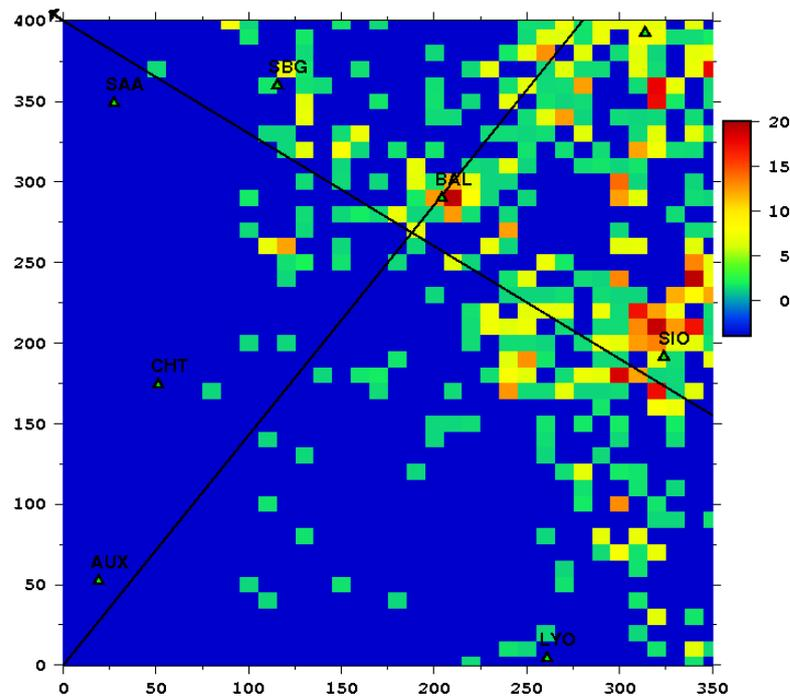
**FIGURE 1.3.3:** Logarithme de l'énergie sismique (en erg) par unité d'aire dans la zone du modèle. Les pixels sont de taille  $5 \times 5$  km. Les lignes noires indiquent les directions N-S et E-O. Le Nord est indiqué par la flèche.
