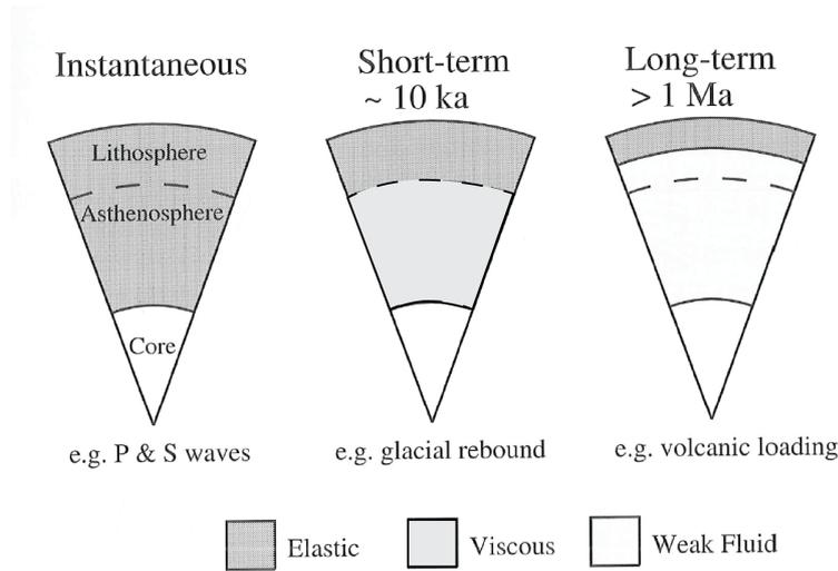
**FIGURE 1.4.1:** Schéma mettant en évidence comment les couches externes de la Terre réagissent à un chargement à différentes échelles temporelles. Modifié d'après Watts (2001).
