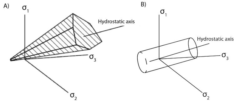
**FIGURE 1.4.4:** Surfaces de rupture dans l'espace des contraintes principales. A) Surface de rupture du critère de Coulomb. B) Surface de rupture du critère de Von Mises.
