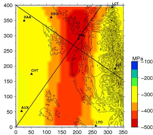
FIGURE 3.2.11:  $\sigma_1 - \sigma_3$  pour la solution crust à 15 km. Voir figure 3.2.8 pour une explication détaillée de la figure.
