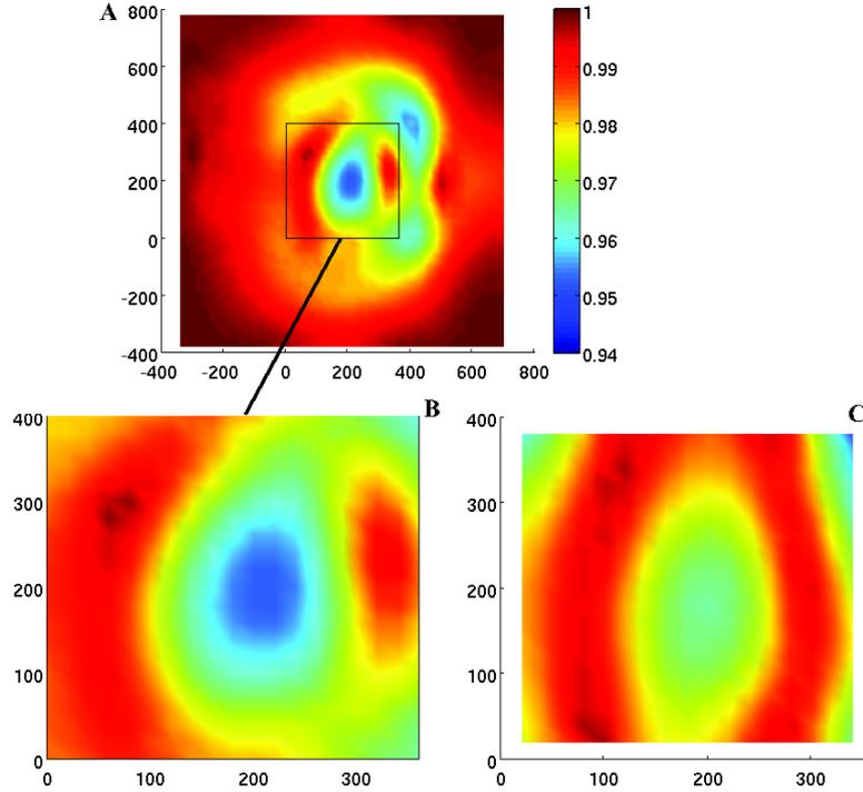
**FIGURE 3.1.9:** Comparaison du rapport  $R$  à 15 km de profondeur pour un modèle élastique. A. Modèle avec les limites étendues. B. Zoom sur la zone d'étude. C. Modèle de la taille de la zone d'étude.
