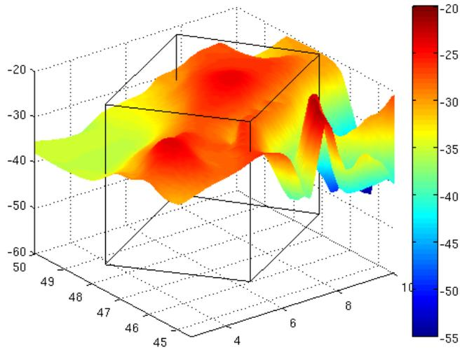
**FIGURE 1.2.3:** *Le modèle de Moho EuCrust07. L'échelle verticale est en kilomètres. Le parallélépipède indique la zone du modèle.*
