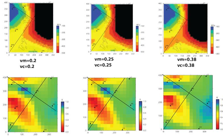
**FIGURE 3.1.11:** *Contrainte différentielle  $\sigma_1 - \sigma_3$  (en haut) et rapport  $R$  (en bas) à 15 km pour différentes valeurs du coefficient de Poisson. Le module d'Young est égal à 75 GPa dans la croûte et 150 GPa dans le manteau.*
