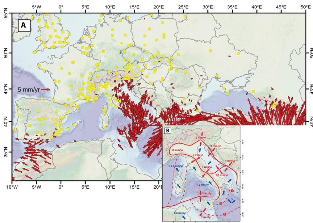
**FIGURE 0.1.2:** Modifié d'après Nocquet (2012). A : Champ de vitesse dans une Eurasie fixe. Les carrés jaunes indiquent un point GPS avec une vitesse inférieure à 1 mm/an. B : modèle cinématique. La collision nord-ouest alpine présente une vitesse inférieure à 1 mm/an tandis que dans les Alpes orientales la convergence est de 2 mm/an.
