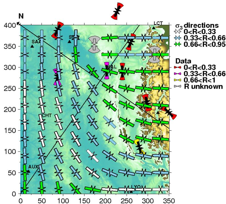
**FIGURE 3.2.2:** Résultats pour le modèle élastique, pour un modèle de la taille de la zone d'étude (360x400 km<sup>2</sup>). Direction de la contrainte principale minimale. Pour une explication détaillée de la figure voir figure 3.2.1.
