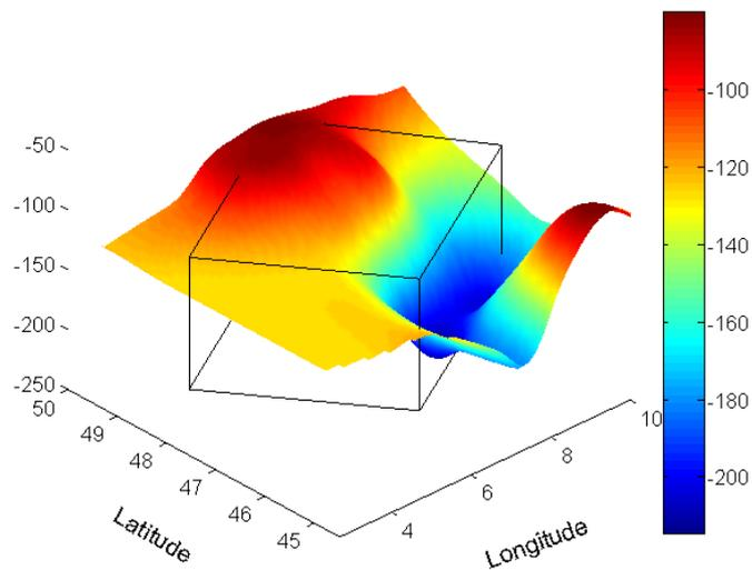
**FIGURE 1.2.8:** Géométrie du LAB utilisée dans le modèle. L'échelle verticale est en kilomètres. Le parallélépipède indique la zone du modèle.
