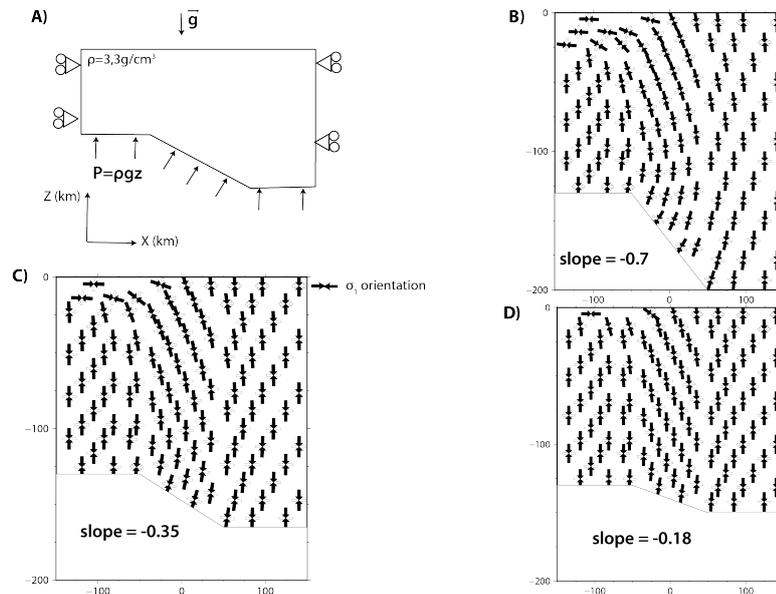
**FIGURE 3.2.5:** *Effet de la pente de la LAB sur les directions de contrainte. A) Géométrie considérée. B) La pente de la LAB est la pente réelle. Cette pente est ensuite diminuée tout en conservant une profondeur minimum fixe ( B) et C ).*
