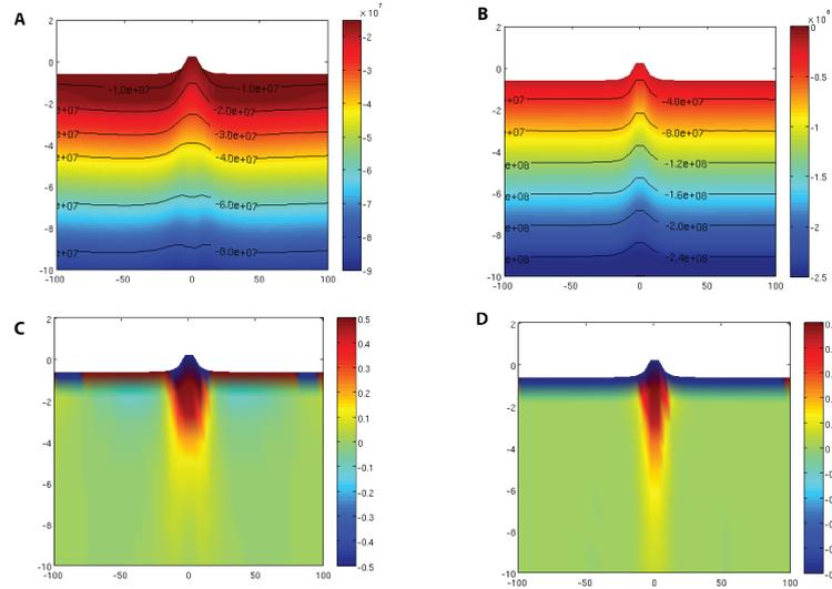
**FIGURE 3.1.6:** *Solution numérique pour une montagne de hauteur  $b=1500$  m et de rapport  $a/b=2$ . A :  $\sigma_{xx}$  ; B :  $\sigma_{zz}$  ; C :  $\frac{\sigma_{xx} - (\nu/(1-\nu))\rho g z}{\nu/(1-\nu)\rho g z}$  ; D :  $\frac{\sigma_{zz} - \rho g z}{\rho g z}$ . L'effet de la montagne décroît rapidement.*
