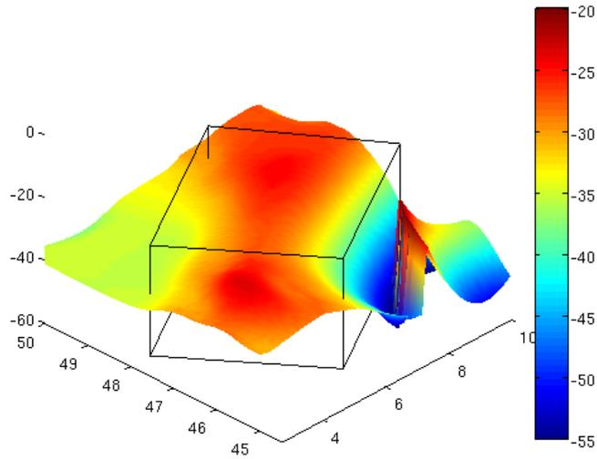
**FIGURE 1.2.5:** *Le modèle de Moho utilisé dans la modélisation. Le modèle de Wagner est complété par le modèle EuCrust dans l'ouest de la zone d'étude. L'échelle verticale est en kilomètres. Le parallélépipède indique la zone du modèle.*
