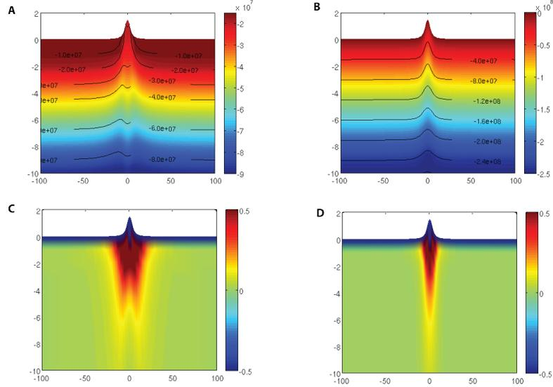
**FIGURE 3.1.4:** Solution analytique pour une hauteur  $b=1500$  m et un rapport  $a/b=2$ . A :  $\sigma_{xx}$  ; B :  $\sigma_{zz}$  ; C :  $\frac{\sigma_{xx} - (\nu/(1-\nu))\rho g z}{\nu/(1-\nu)\rho g z}$  ; D :  $\frac{\sigma_{zz} - \rho g z}{\rho g z}$ . L'effet de la montagne décroît rapidement.
