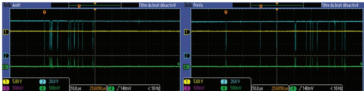
Figure 158 - Usinage assisté par vibrations : plus de 10 décharges par  $T_{\text{ON}}$ .
