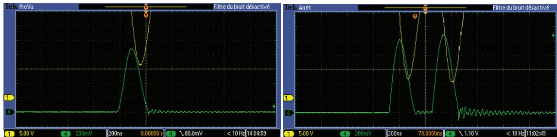
**Figure 128 - Comportement du courant et de la tension lors des décharges.**
