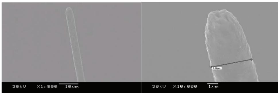
Figure 65 - Extrémité d'un micro-outil de 4  $\mu\text{m}$  de diamètre et de longueur 80  $\mu\text{m}$  ( $Ff = 20$ ).
