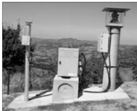
Figure 2.11. « Station Totale » automatisée (d'après Corsini et al. 2009a).
