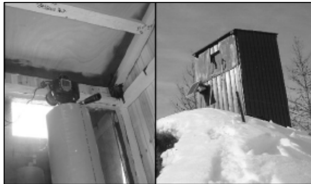
Figure 2.4. Installation du système d'acquisition photographique dans une cabane située en face du glissement de terrain de Super-Sauze (d'après Travelletti et al. 2011).
