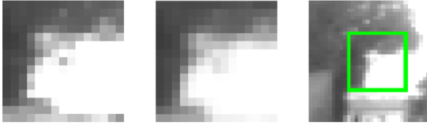
FIGURE 4.6 – Images intervenant lors de la corrélation. A gauche, le descripteur correspondant à l’amer lors de son initialisation. Au centre, la prédiction de ce descripteur au moment de la corrélation et après mouvement du système, et à droite, la position dans la zone d’incertitude où ce descripteur prédit a été trouvé en maximisant le score ZNCC.
