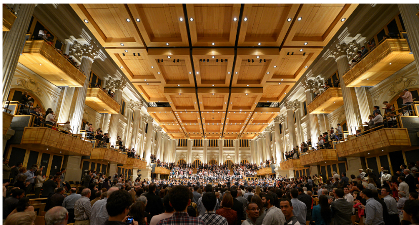
FIGURE 1.2 – Vue de la Sala à São Paulo, Brésil. Les unités qui composent le plafond sont mobiles en hauteur. Inauguration : 1999. Acousticiens : Artec et Acoustica & Sonica.
