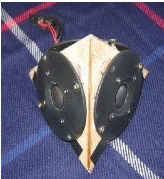
FIGURE A.3.3 – Photographie de la source sonore tétraédrique.
