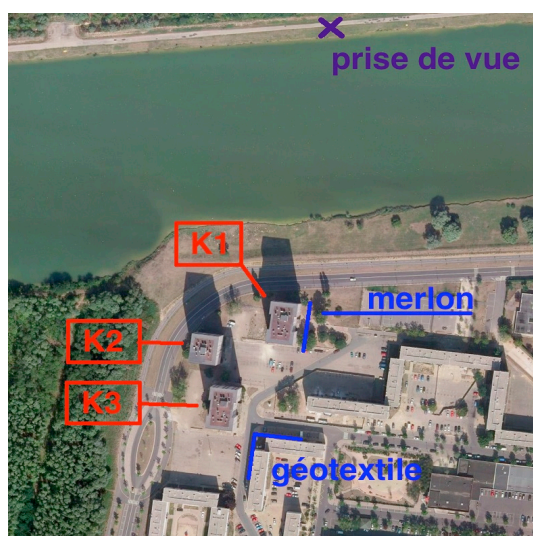
Figure 24 : Implantation des bâtiments, dispositif de protection, et de prise de vue pour le site de mante la jolie
