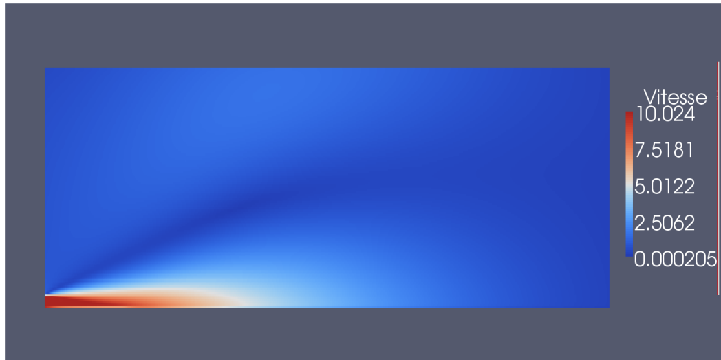
Figure 87 : Distribution de la vitesse dans la zone d'injection
