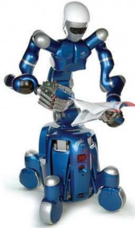
FIGURE 1.2 – L’humanoïd Justin , une solution à la manipulation mobile (dextre).
