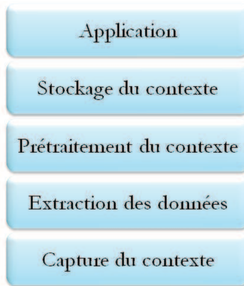
FIGURE 1.7 – Architecture générale d'un système sensible au contexte
