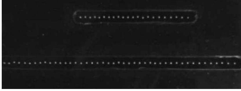
FIGURE I.4 – Image de deux cellules rectilignes contenant N_{tot} = 22 et 32 billes chargées pour une tension V_0 = 1000 V. Les cellules sont de longueur L = 25 et L = 57 mm.
