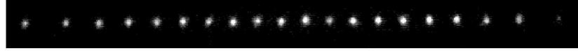
FIGURE 1 – Block, J. Phys. B., 33, 375 (2000), figure 2 : chaîne d’ions piégés à basse température dans un piège de Paul.
