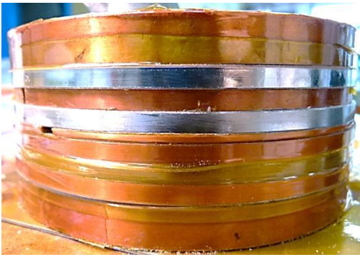
11- Bobine avant la jonction haute
