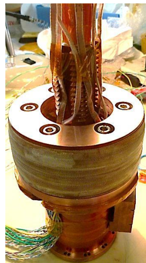
14- Montage de la bobine sur l'échangeur
