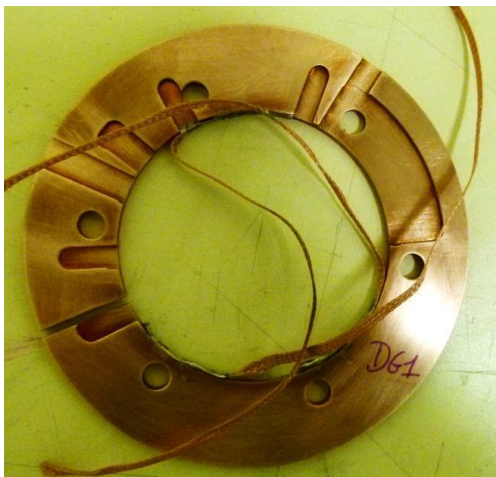
c- Plaque de cuivre de refroidissement
