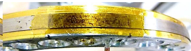
14- Ajout d'un ruban de Kapton localement au niveau du lap joint pour réduire la dissipation thermique dans l'air.
