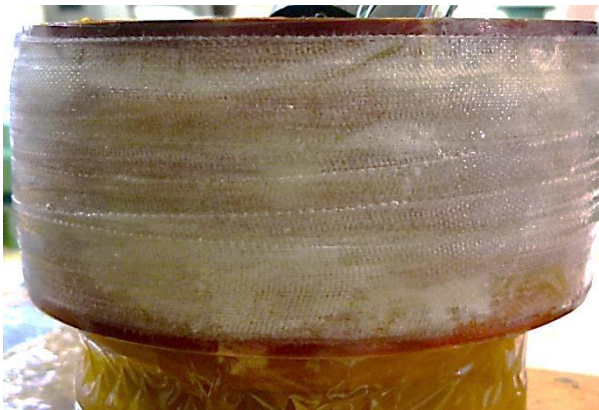
13- Bobine HTS2 après imprégnation fibre de verre
