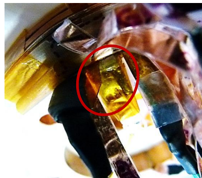
(b) - Insertion d'une feuille de Kapton pour corriger la déchirure de l'isolant de la chaufferette.
