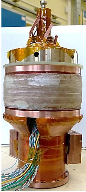
15- Bobine montée sur l'échangeur
