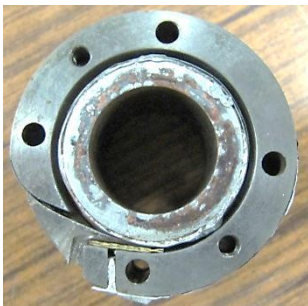
2- Demi-galette finie avec les rubans de cuivre pour les prises de potentiel (droite : après démontage)
