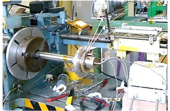
1- Système de chauffage pour la soudure du ruban sur le mandrin des galettes simples
