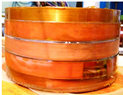
e- Bobine finale avec les jonctions
