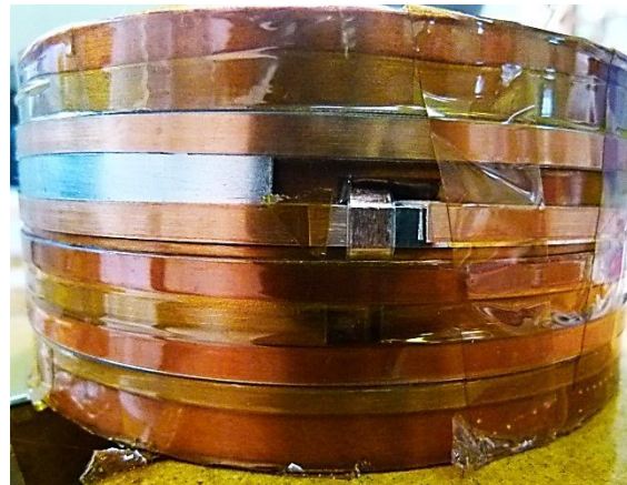
d- Bobine avec les jonctions
