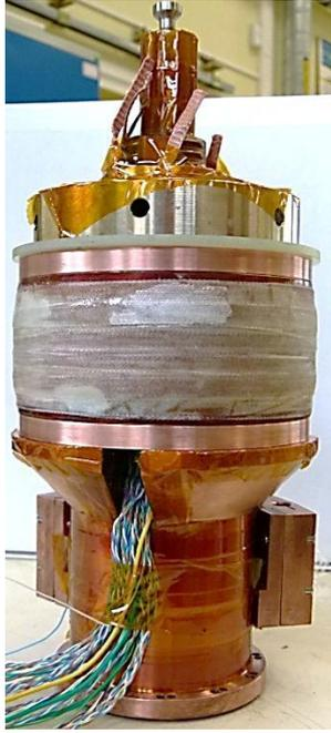
15- Bobine montée sur l'échangeur
