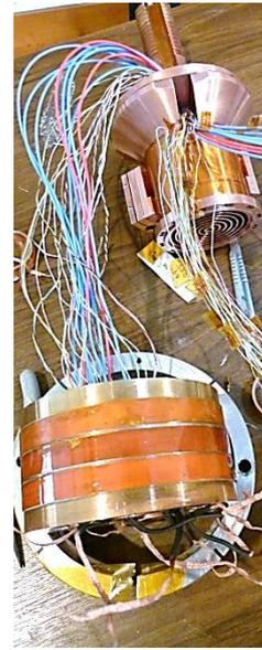
13- Montage de la bobine sur l'échangeur
