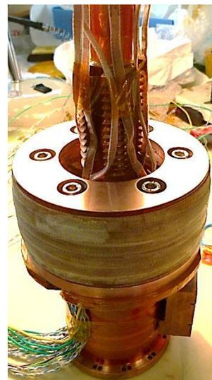
14- Montage de la bobine sur l'échangeur
