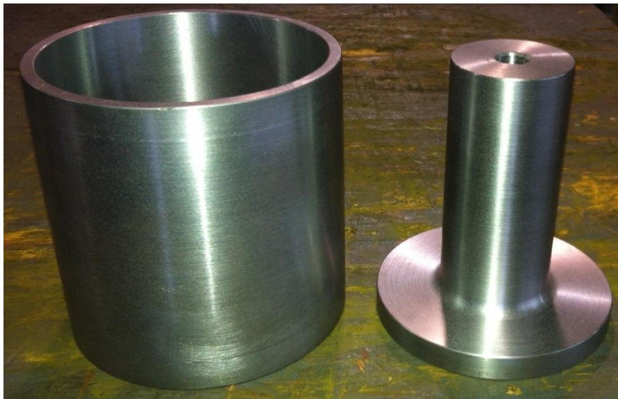
Figure 4-9 Noyaux magnétiques du coupleur coaxial. Le stator (à gauche) et le rotor (à droite).
