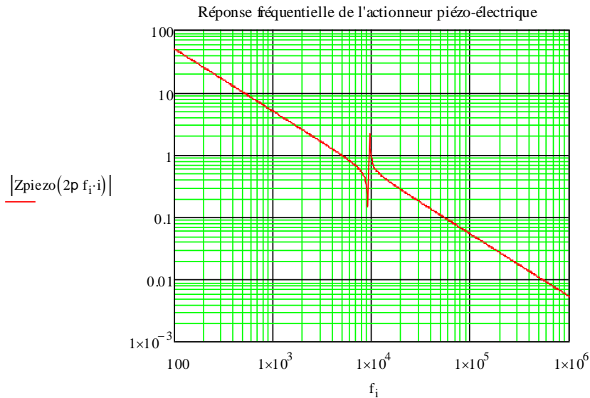
Figure 1-5 Réponse fréquentielle d'un actionneur piézo-électrique.
