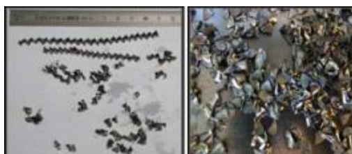
Figure 1-2 Copeaux obtenus lors du perçage traditionnel (à gauche) et du perçage vibratoire (à droite).
