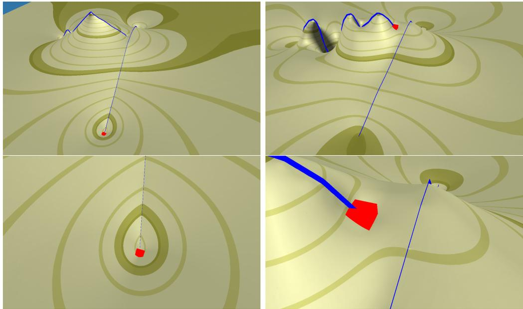
FIGURE 4.2 – Comparaison de deux terrains : l'un généré avec une simple équation harmonique de diffusion (à gauche), l'autre généré avec une équation bi-harmonique (à droite). La continuité  $C^1$  est garantie à l'endroit des contraintes (courbes bleues) dans le cas de l'équation bi-harmonique et non dans le cas de l'équation harmonique. Les lignes de niveaux, plus foncées, sont  $C^0$  à gauche mais  $C^1$  à droite.
