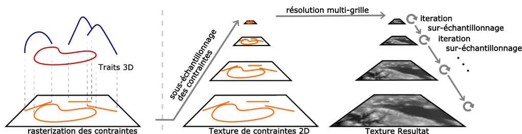
FIGURE 4.5 – Schéma d'ensemble de la génération de terrain.
