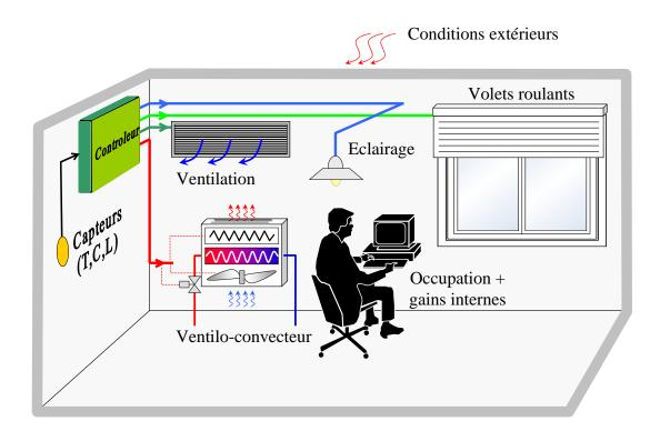
**Figure A.4** Représentation d'une zone du bâtiment: une zone est espace contigu du bâtiment disposant d'un certain nombre d'actionneurs (chauffage, ventilation, volets roulants, éclairage artificiel, ...) ainsi que de capteurs d'ambiance.
