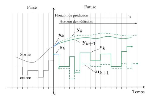
**Figure A.1** Commande à horizon glissant: à chaque instant de décision une nouvelle séquence de commande  $u_k$  est calculée, seul le premier élément de la séquence ( $u_k$ ) est mis en œuvre.
