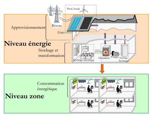
Figure A.2 Décomposition du bâtiment- niveau énergie et niveau zone
