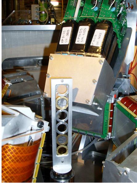
FIGURE 3.20 – *Prototype du calorimètre EXL muni de sa plaque d'aluminium de protection et porte-cible.*
