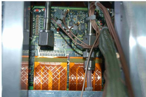
FIGURE 3.17 – *Système de refroidissement de MUST2.*
