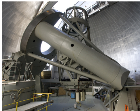
FIGURE 1.13 – Télescope de 5 mètre du Mont Palomar : Les instruments dont le Palomar Fiber Nuller viennent se fixer directement au dos du miroir primaire. Crédit : http://www.astro.caltech.edu/palomar
