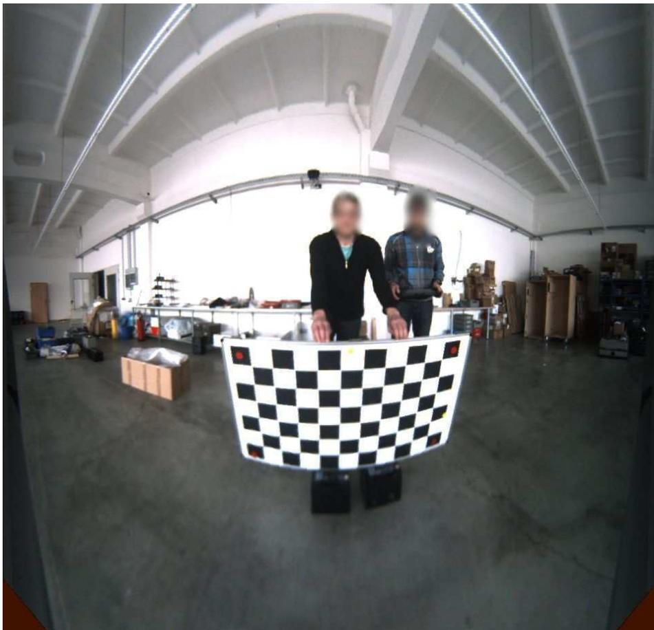
**Figure 73 Mire utilisée pour la calibration caméra-laser**
