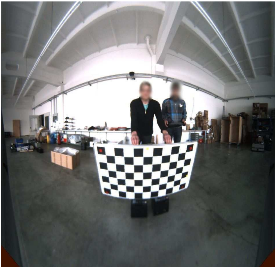
Figure 73 Mire utilisée pour la calibration caméra-laser
