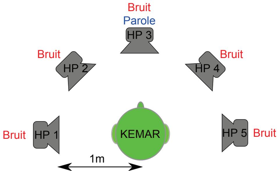
FIGURE 3.2 – Plan d’enregistrement des différentes pistes
