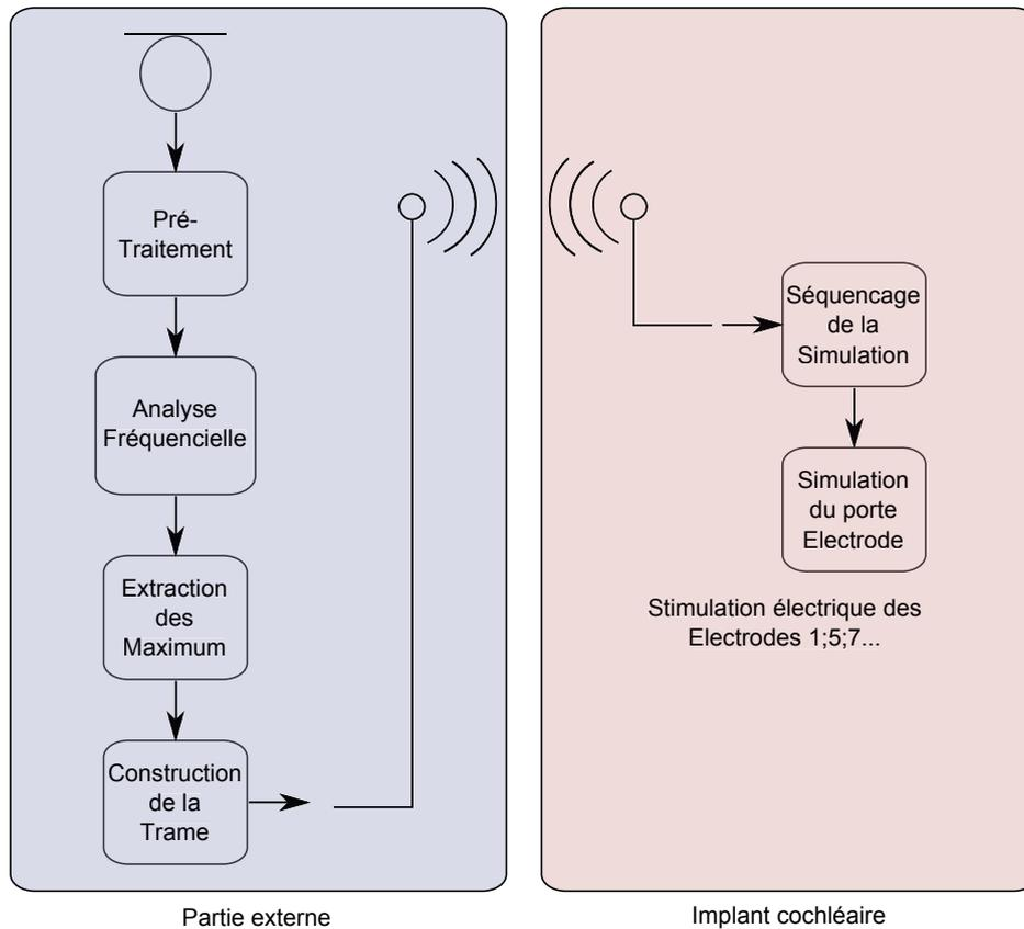
FIGURE 2.2 – Principe de fonctionnement de l’implant cochléaire
