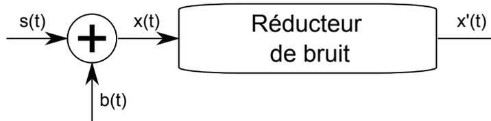
FIGURE 1.2 – Modèle de débruitage mono-voie
