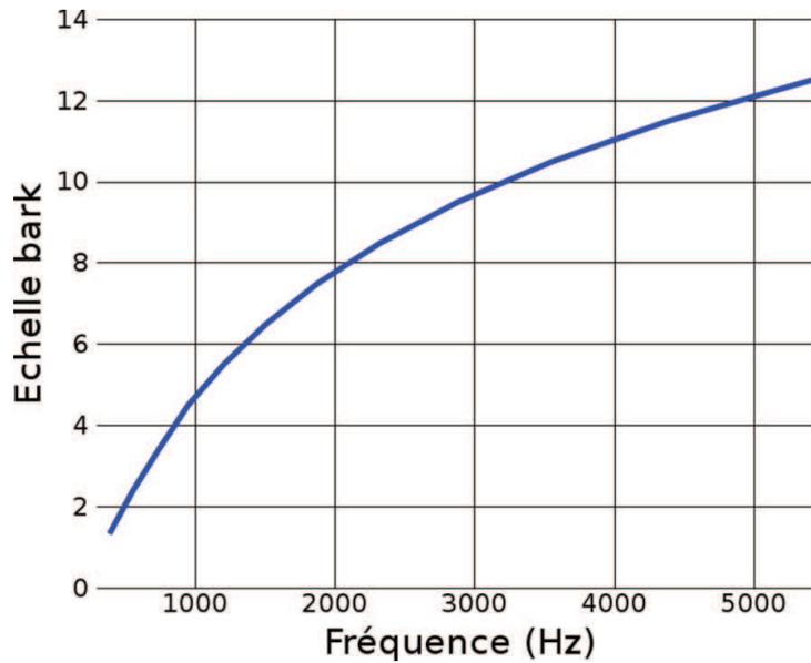
FIGURE 2.6 – Répartition fréquentielle suivant l'échelle de bark
