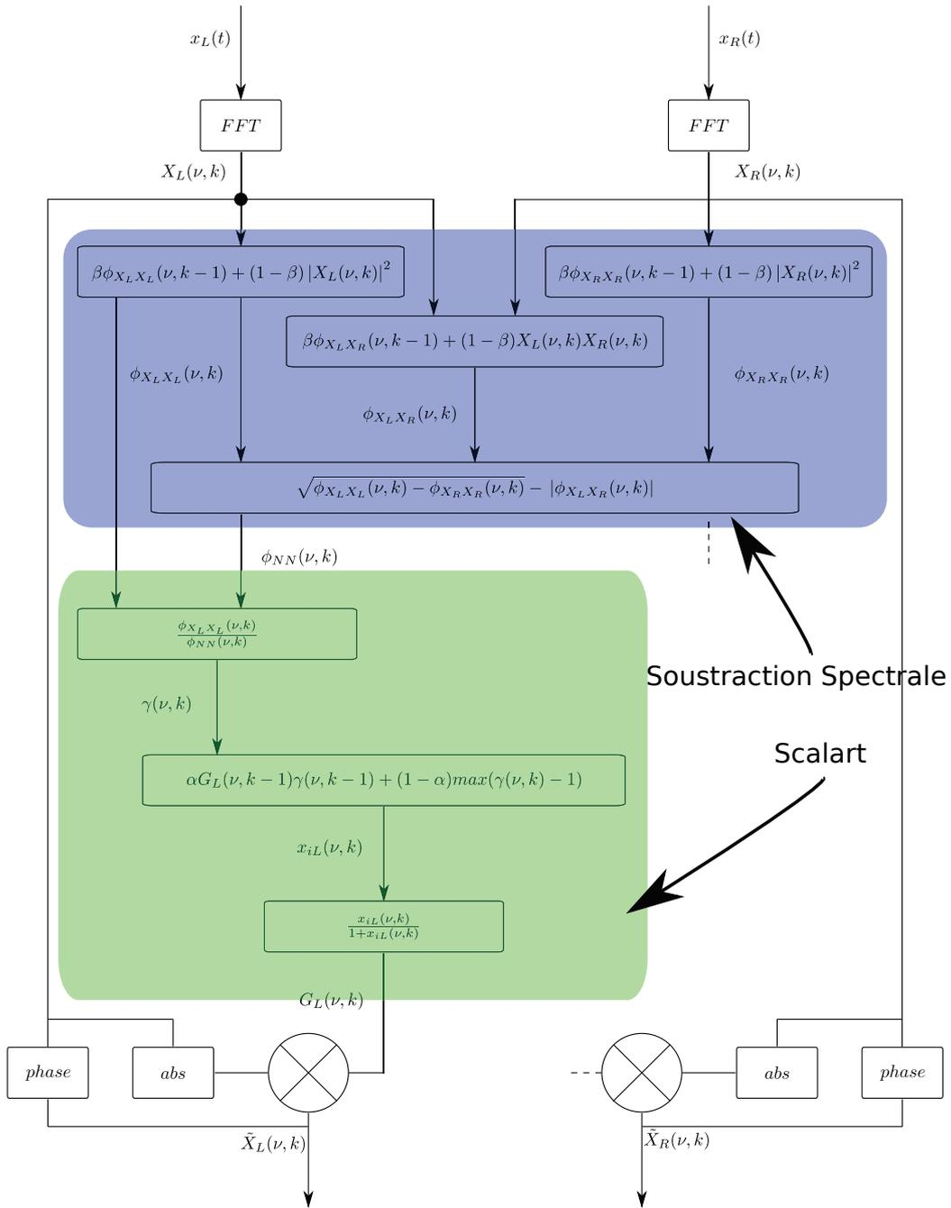
FIGURE 1.6 – Synoptique de Doerbecker combiné avec Scalart
