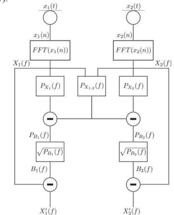
Figure 1 : Synoptique de la soustraction spectrale binaurale
