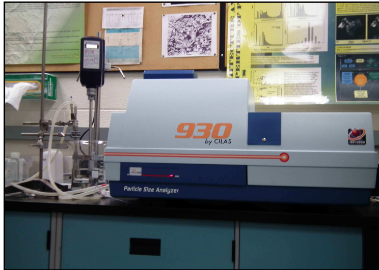
FIG. 5.3 – Photographie du granulomètre laser et de la cellule de cisaillement (à gauche du granulomètre).
