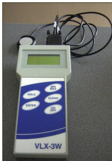
Figure II.A.5: Radiomètre VLX-3W équipé d'une sonde CX.
