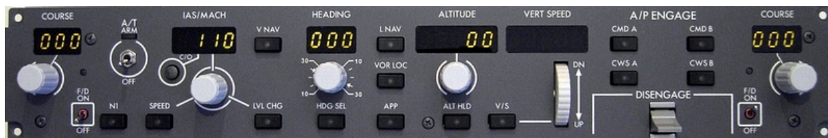
Figure 12 : Exemple de panneau de guidage (Flight Control Unit ou Mode Control Panel) 19
