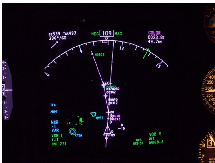
Figure 10 : Ecran de visualisation des paramètres de route (Navigation Display, ND) de Boeing 747-400 16
