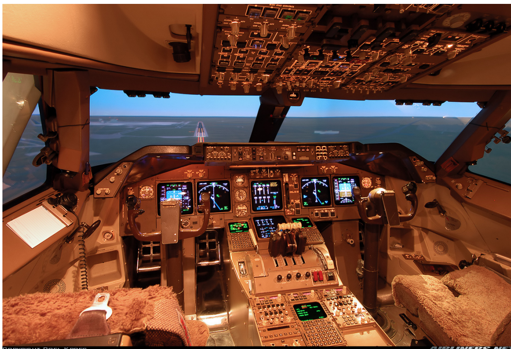
Figure 7 : Cockpit de Boeing 747-400 : le manche est face au pilote, la poignée des gaz entre les deux pilotes 9
