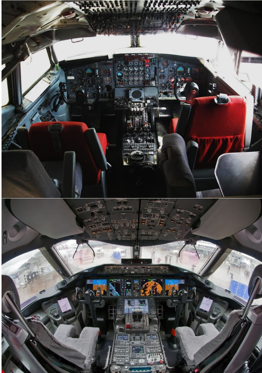
Figure 8 : Cockpit des Boeing 707 (1959, en haut 10 ) et 787 (2011, en bas 11 )
