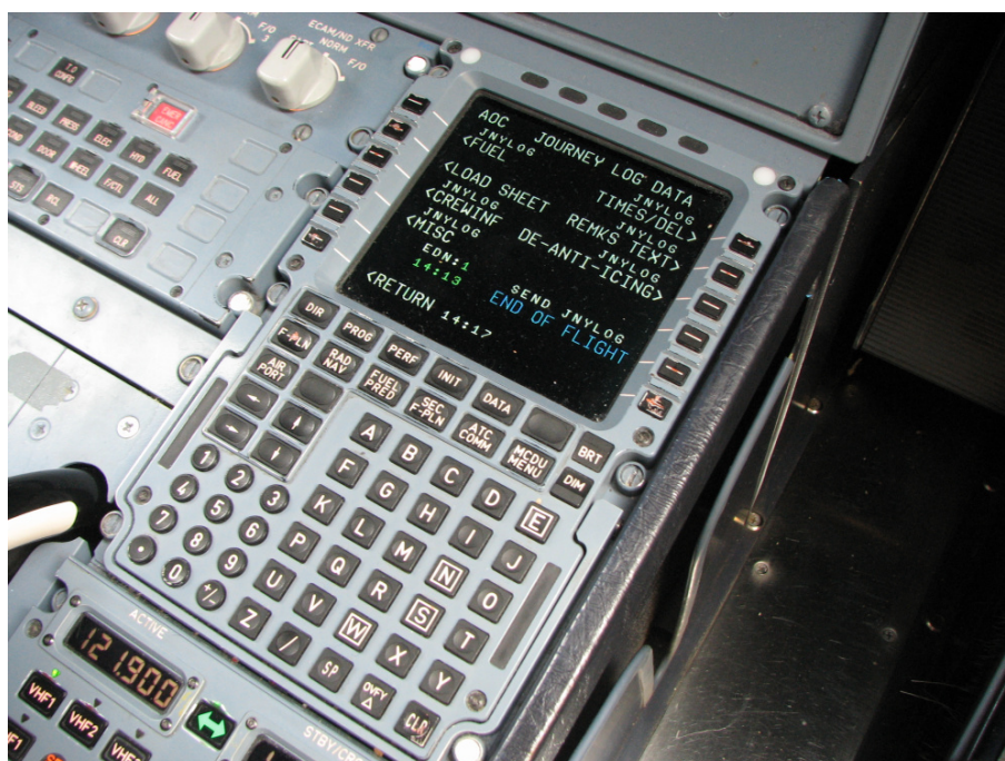
Figure 11 : Panneau de contrôle (MCDU) de l'ordinateur de bord ( Flight Management System ) 18
