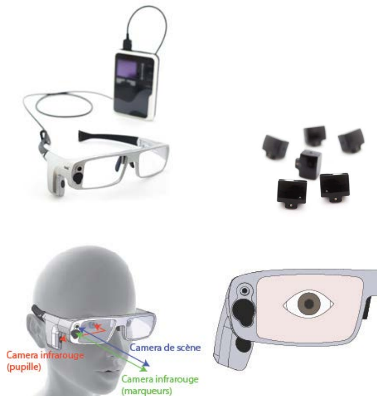
Figure 90 : Oculomètre portatif Tobii Glasses, son boîtier d'acquisition et les marqueurs infrarouges (d'après Tobii Glasses Eye Tracker User Manual).
