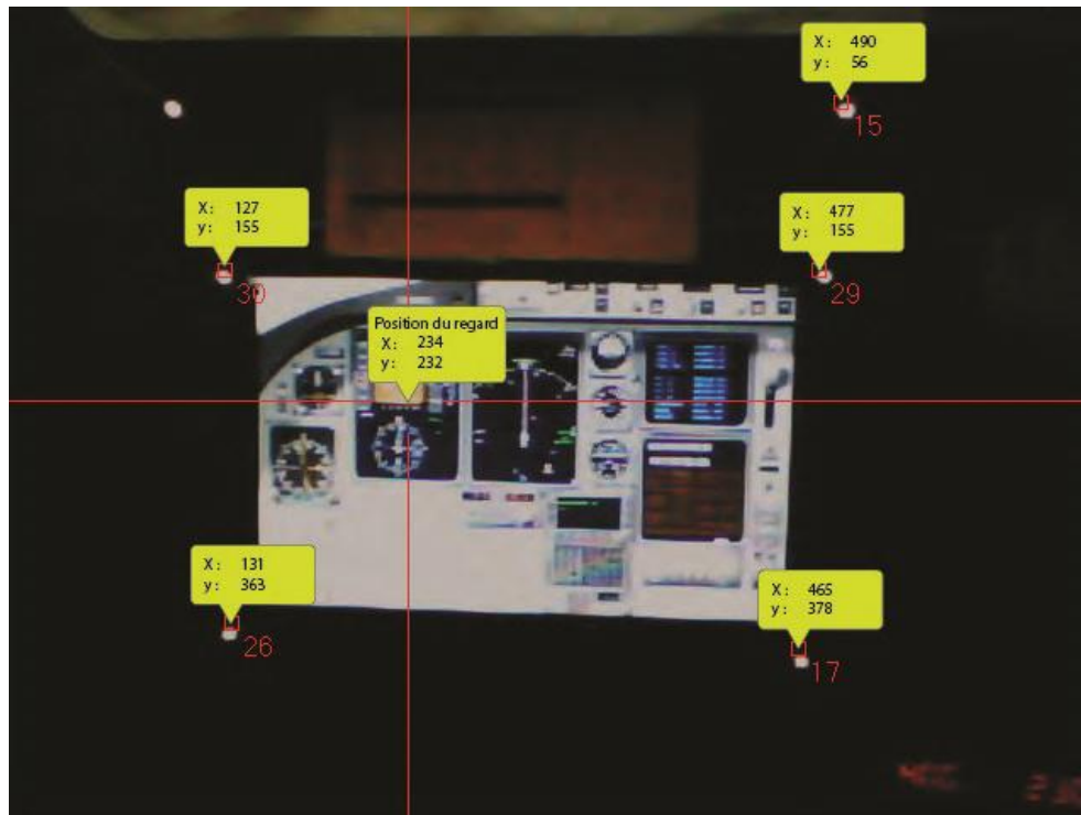
Figure 95 : Position et coordonnées du regard et des marqueurs infrarouges sur une image issue de la caméra de l'oculomètre (référentiel égocentré)
