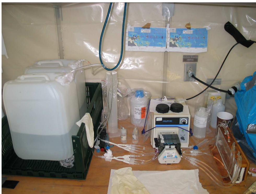
FIGURE 2.8 – Système de préconcentration de l'échantillon en phase aqueuse : fixation des REE sur les cartouches SeqPak C18. Les détails sont donnés dans le texte.
