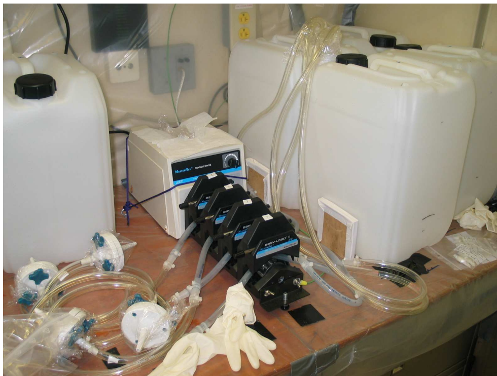
FIGURE 2.7 – Système de filtration des échantillons pour séparer la phase aqueuse de la phase particulaire.
