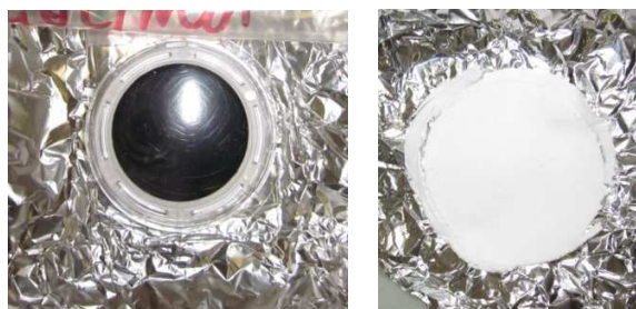
Figure 31: Comparaison d'un filtre obtenu après prélèvement des échappements directs d'un véhicule Euro 3 diesel (à gauche) et d'un véhicule Euro 2 essence (à droite)
