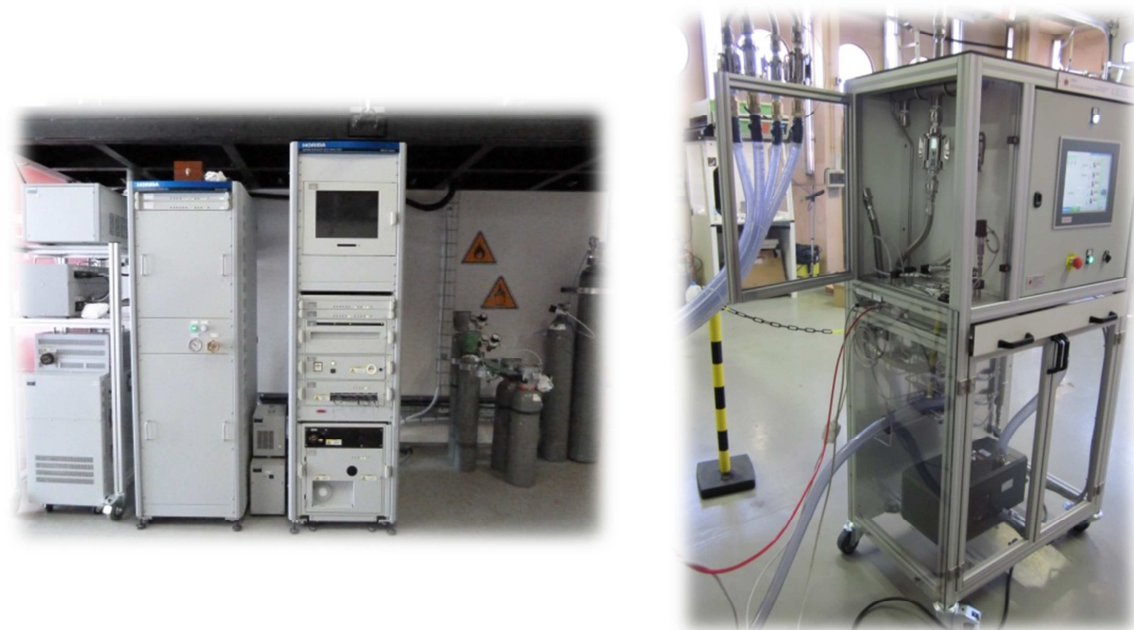
Figure 16: Baie d'analyse (HORIBA) des polluants réglementés (à gauche) et baie de prélèvement (Serv'Instrument) des polluants non réglementés (à droite)
