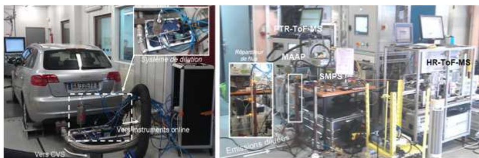
Figure 20: Montage expérimental mis en place pour les mesures à l'émission avec l'instrumentation de la plateforme MASSALYA.
