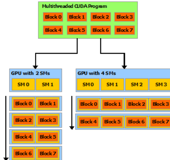
FIGURE 4.24 – Le paradigme de programmation CUDA permet une scalabilité des blocs en fonction du nombre de multiprocesseur embarqués sur la carte GPU.
