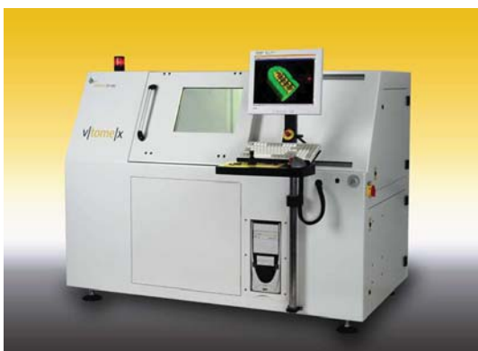
Figure 2.6a : Dispositif de tomographie du laboratoire (phoenix-xray)
