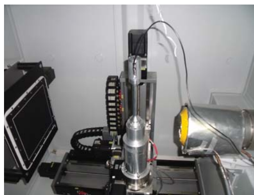
Figure 2.6b : Détail du système : une source, un détecteur, une platine de rotation.
