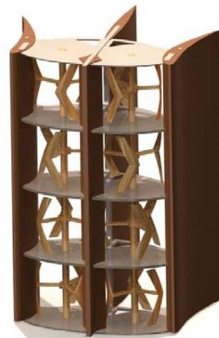
Figure 2.6. Tour bi colonnes avec carénage ©[ACH-09]
