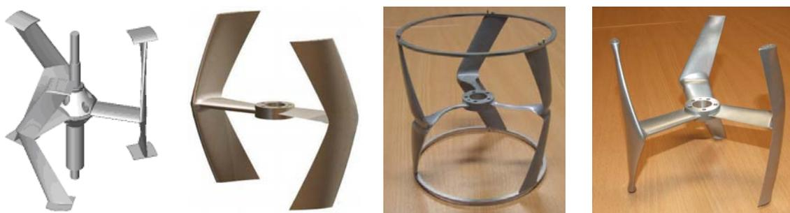
Figure 2.1. La turbine Achard – différentes variantes de réalisation ©[ACH-05]
