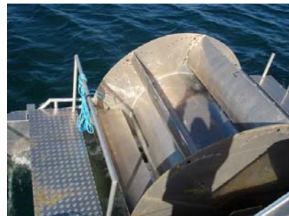
Figure 1.17. Rue à aube de Hydro-Gen – vue de dessus ©[HGN-09]
