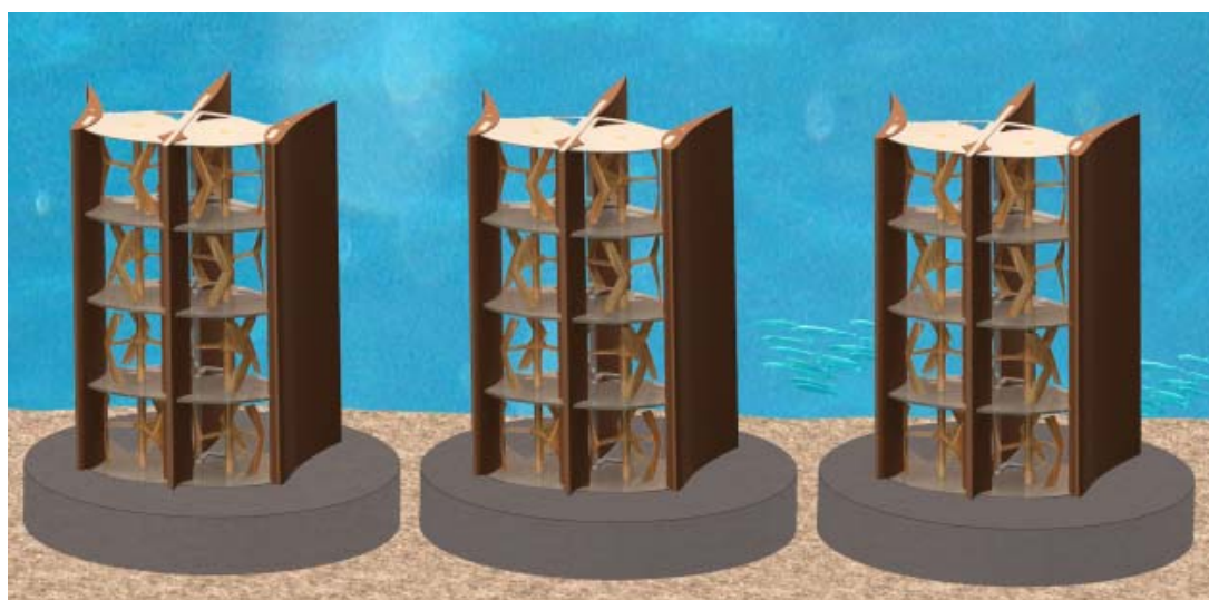
Figure 2.7. Schéma d'une configuration possible de parc hydrolien HARVEST ©[ACH-09]
