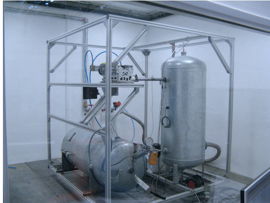
Figure II-7. Vue du montage permettant les essais instationnaires en configuration écoulement rentrant dans un volume
