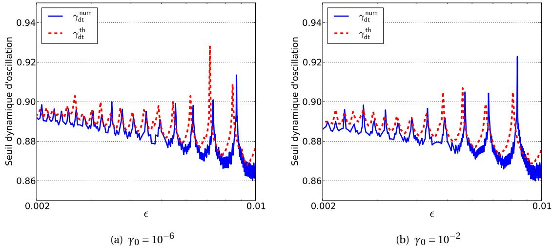
**Figure C.4** – Seuil dynamique numérique  $\gamma_{dt}^{num}$  (ligne bleue) et théorique  $\gamma_{dt}^{th}$  obtenu par (C.22) (pointillés rouges). (a)  $\gamma_0 = 10^{-6}$  et (b)  $\gamma_0 = 10^{-2}$ .  $\zeta = 0.5$  et la précision utilisée est de 200 chiffres significatifs.
