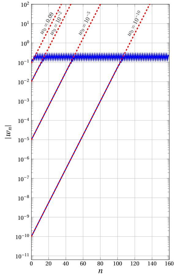
**Figure 1.11** – Enveloppe de  $w$  définie par (1.50). (—) Enveloppe calculée à partir de la solution numérique de (1.33) et (- - -) enveloppe théorique déduite de la fonction (1.53). Une échelle logarithmique est utilisée pour l'axe des ordonnées.  $\gamma = 0.42$ ,  $\zeta = 0.5$  et  $\lambda = 1$ .
