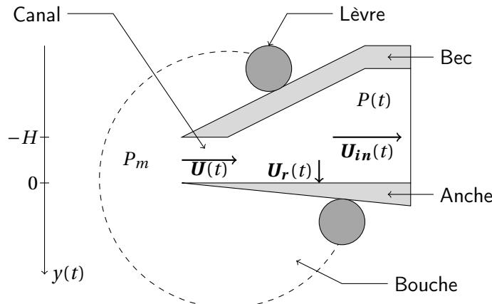
**Figure 1.3 – Schéma de principe d'un bec à anche simple de type bec de clarinette ou de saxophone.**
