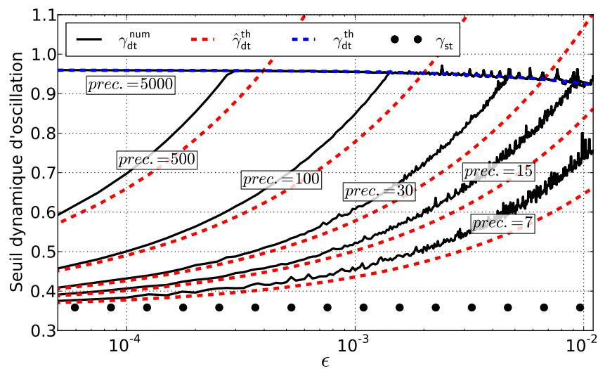
**Figure 3.11** – Représentation de  $\gamma_{dt}^{num}$  (ligne noire) en fonction de  $\epsilon$  pour différentes précisions (prec. = 7, 15, 30, 100, 500 and 5000). Comparaison avec les seuils théoriques statique  $\gamma_{st}$  (points noirs) et dynamiques  $\gamma_{dt}^{th}$  (pointillés bleus) et  $\hat{\gamma}_{dt}^{th}$  (pointillé rouge).  $\gamma_0 = 0$ ,  $\zeta = 0.5$  et  $\lambda = 0.95$ .
