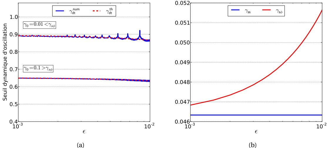
**Figure C.2** – (a) Seuil dynamique  $\gamma_{dt}^{num}$  calculé sur la simulation du système (2.23) comparé à la prédition théorique  $\gamma_{dt}^{th}$  obtenu par la résolution de l’équation (2.36) pour  $\gamma_0 = 0.01 < \gamma_{s\phi}$  (courbes du haut) et  $\gamma_0 = 0.1 > \gamma_{s\phi}$  (courbe du bas). (b) Point  $\gamma_{s\phi}$  et point superstable  $\gamma_{ss}$  en fonction de  $\epsilon$ .  $\zeta = 0.5$  et la précision utilisée est de 200 chiffres significatifs.
