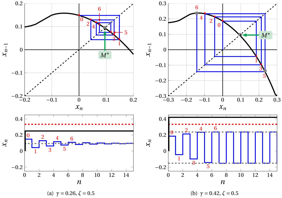
**Figure 1.8** – En haut : fonction  $f$  (—), fonction identité (---) et principe de résolution graphique de (1.33). En bas : (—) profil temporel de  $x_n$ , (—) profil temporel de  $\gamma$  de type Heaviside, (- - -) seuil statique d'oscillation  $\gamma_{st}$ , (- - -) amplitude du régime établi.  $\zeta = 0.5$  et  $\lambda = 1$ . (a)  $\gamma = 0.26 < \gamma_{st}$ , le régime établi est non oscillant et (b)  $\gamma = 0.42 > \gamma_{st}$ , le régime établi oscillant à deux états.
