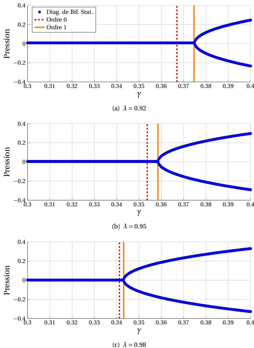
**Figure B.2 –** (a), (b) et (c) Représentation du diagramme de bifurcation statique (points bleus) et du seuil statique d'oscillation donné par (B.13) (ordre 0 : pointillés rouges ; ordre 1 ligne orange) pour trois valeurs du paramètre de pertes  $\lambda$  : (a)  $\lambda = 0.92$ , (b)  $\lambda = 0.95$ , valeur typique pour une clarinette et (c)  $\lambda = 0.98$ .  $\zeta = 0.5$ .
