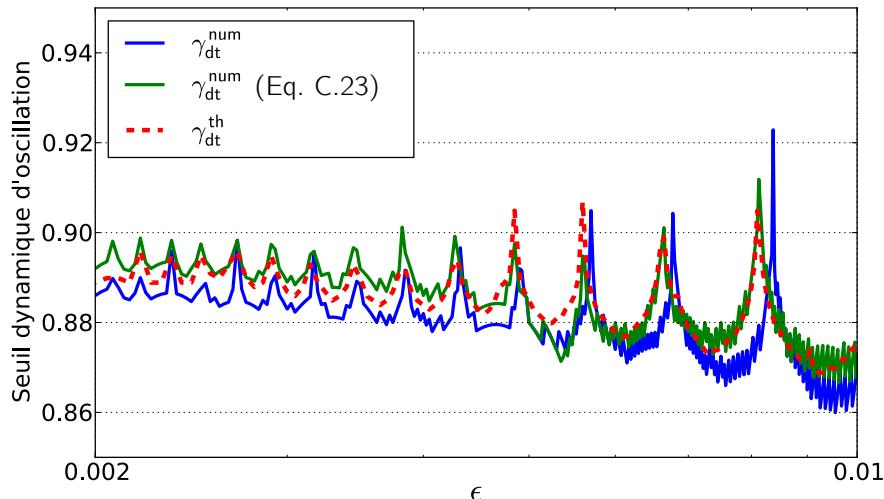
**Figure C.5** – Seuils dynamiques numériques  $\gamma_{dt}^{num}$  (ligne bleue) calculé sur la simulation du système non linéaire (2.23) et (ligne verte) sur la simulation du système linéarisé autour de la courbe invariante (2.32) et seuil théorique  $\gamma_{dt}^{th}$  obtenu par (C.22) (pointillés rouges).  $\zeta = 0.5$  et  $\gamma_0 = 10^{-2}$ .
