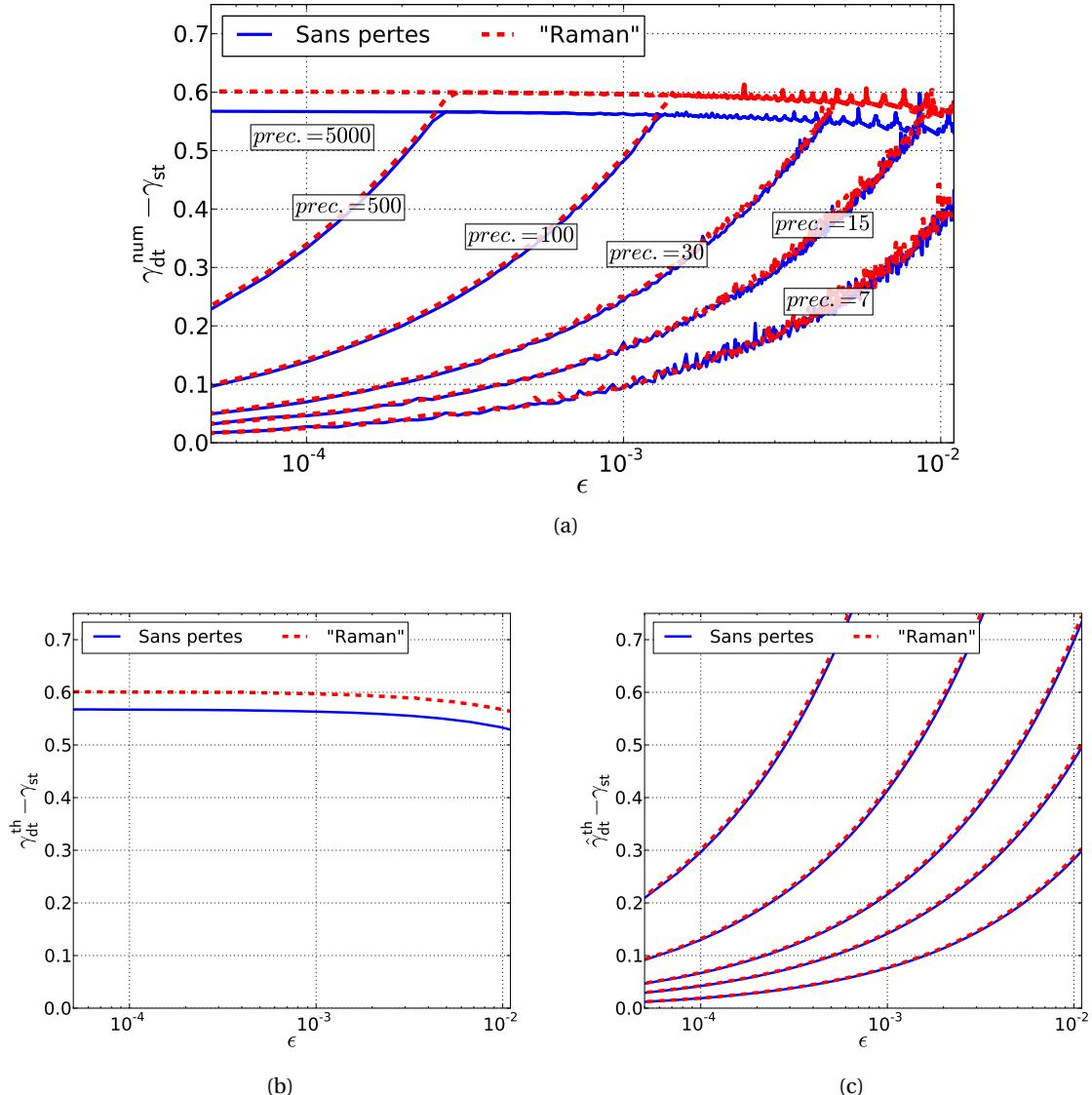
**Figure 3.12 – Seuil d'oscillation dynamique moins le seuil d'oscillation statique en fonction de  $\epsilon$  pour différentes précisions (prec. = 7, 15, 30, 100, 500 and 5000) : (ligne bleue)  $\lambda = 1$  et (pointillés rouges)  $\lambda = 0.95$ .
