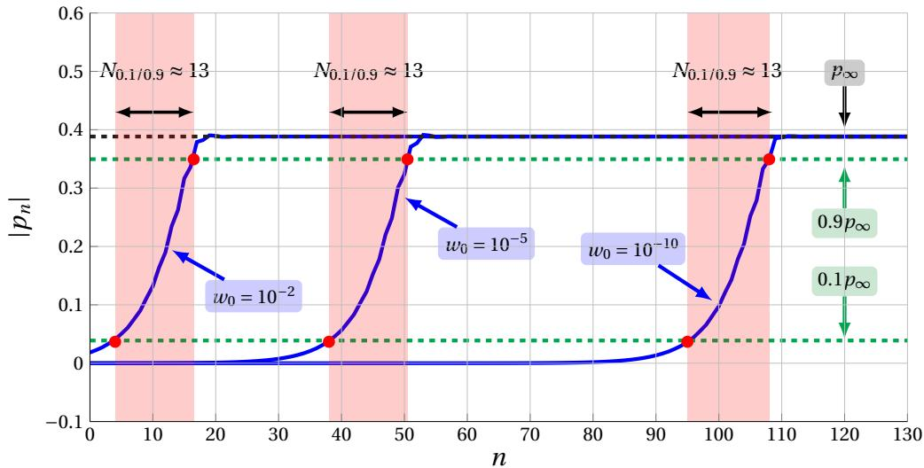
**Figure 1.12** – Enveloppe temporelle de la pression  $p$  dans le bec reconstruite à partir de la variable  $x$  (solution de (1.33)) en utilisant les équations (1.21) et (1.30). Le profil de l'onde aller  $x$  est obtenu pour  $w_0 = 10^{-2}$ ,  $w_0 = 10^{-5}$  et  $w_0 = 10^{-10}$ . La longueur du transitoire  $N_{0.1/0.9}$  définie par l'équation (1.54) est indiquée pour chacune des trois enveloppes.  $\gamma = 0.42$ ,  $\zeta = 0.5$  et  $\lambda = 1$ .
