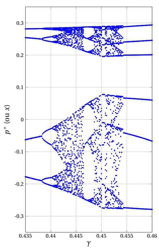
**Figure 1.7** – Diagramme de bifurcation *statique* de modèle du clarinette de Raman (équation (1.33)) pour  $\lambda = 0.95$  et  $\zeta = 0.8$ . Diagramme correspondant à la variable  $p^+$  (ou  $x$ ) tracé entre  $\gamma = 0.435$  et  $\gamma = 0.46$ . Le diagramme est obtenu en simulant 1000 itérations de l'équation (1.33) puis en prenant les 40 dernières valeurs des orbites obtenues.
