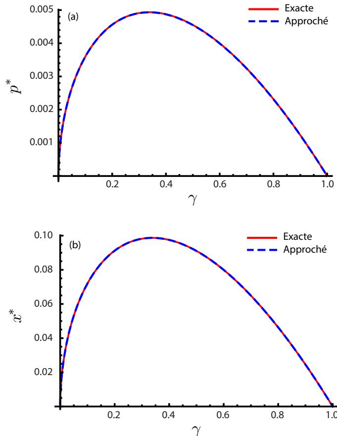
**Figure B.1 –** (a) Comparaison entre l'expression exacte de  $p^*(\gamma)$  (cf. équation (B.2) ; ligne rouge) et l'expression approchée (cf. équation (B.10) ; ligne pointillée bleue). (b) Même comparaison pour  $x^*(\gamma)$ .  $\zeta = 0.5$  et  $\lambda = 0.95$ .
