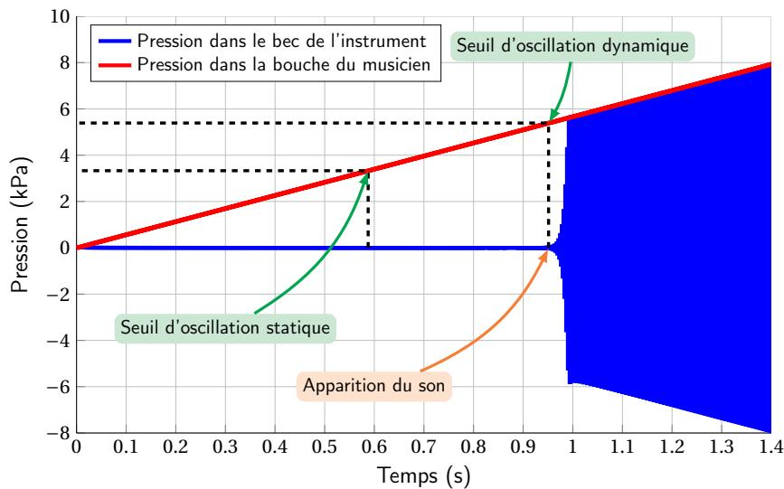
**Figure 1.2** – Simulation du modèle de clarinette dit "de Raman" (cf. section 1.2.4) où la pression dans la bouche du musicien augmente linéairement dans le temps. L'apparition du son apparaît à une valeur de pression dans la bouche, *seuil d'oscillation dynamique*, supérieur au *seuil d'oscillation statique* théorique [59].
