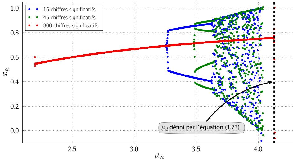
Figure 1.18 –  $x_n$  obtenu par simulation du système (1.57) pour différentes précisions de calculs : 15 (•••), 45 (•••) et 300 (•••).  $\epsilon = 0.001$ ,  $x_0 = 0.6$  et  $\mu_d$  est le point de bifurcation dynamique déterminé par l'équation (1.73).
