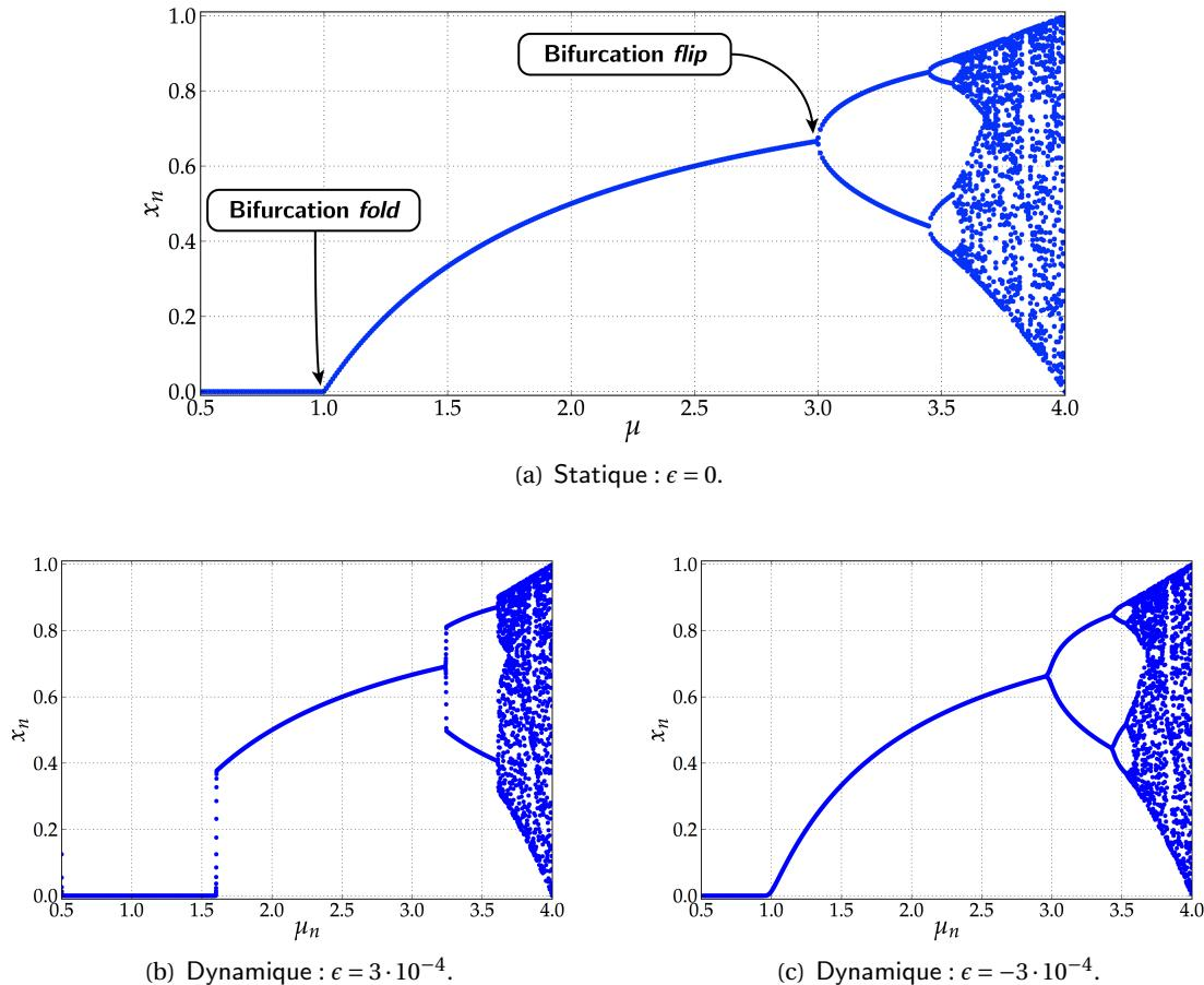
**Figure 1.13 – Diagramme de bifurcation de la suite logistique.** (a) Diagramme statique :  $\mu$  est constant. (b) Diagramme dynamique avec croissance positive de  $\mu_n$ ,  $\epsilon = 3 \cdot 10^{-4}$  et  $\mu_n \in [\mu_0 = 0, \mu_N = 4]$ . (c) Diagramme dynamique avec croissance négative de  $\mu_n$ ,  $\epsilon = -3 \cdot 10^{-4}$  et  $\mu_n \in [\mu_0 = 0.5, \mu_N = 4]$ .
