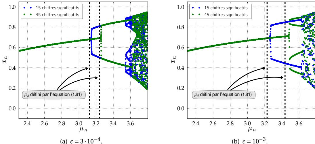
**Figure 1.19** –  $x_n$  obtenu par simulation du système (1.57) pour différentes précisions de calculs : 15 (•••) et 45 (●●●).  $x_0 = 0.6$  et  $\hat{\mu}_d$  est le point de bifurcation dynamique déterminé par l'équation (1.81). (a)  $\epsilon = 3 \cdot 10^{-4}$  et (b)  $\epsilon = 10^{-3}$ .
