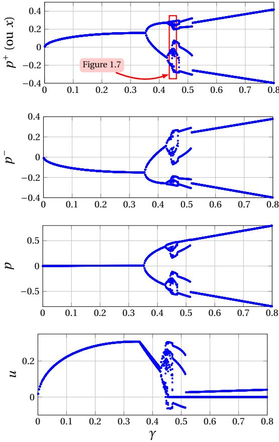
**Figure 1.6** – Diagrammes de bifurcation *statiques* du modèle du clarinette de Raman (équation (1.33)) pour  $\lambda = 0.95$  et  $\zeta = 0.8$ . De haut en bas : diagramme en  $p^+$  (ou  $x$ ),  $p^-$ ,  $p$  et  $u$ . Ces diagrammes sont obtenus en simulant 400 itérations de l'équation (1.33) puis en prenant les 20 dernières valeurs des orbites obtenues. Cette méthode est tirée de [84] où elle est aussi vérifiée.
