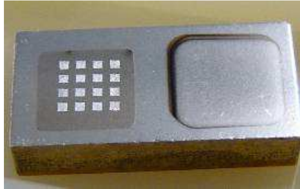
Figure 4-5 Image d'un échantillon test après dépôt de multicouche
