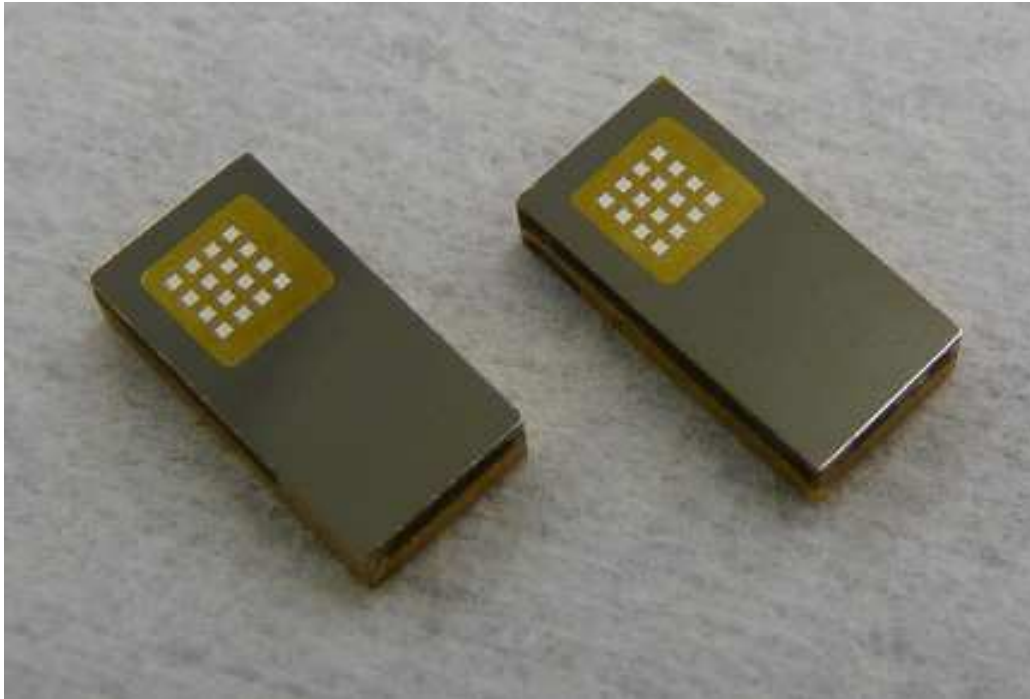
Figure 4-6 Deux échantillons prêts à être assemblés photographiés à la fin du procédé détaillé dans le texte
