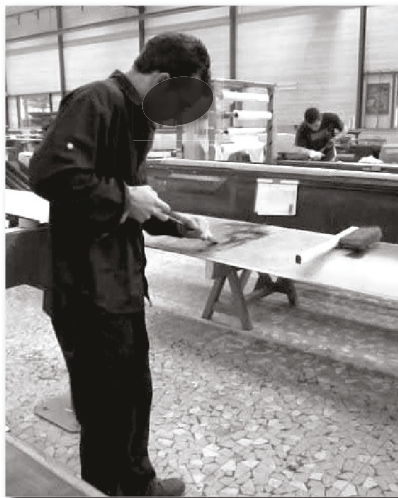
Figure 22 : Déconstruction au grattoir
