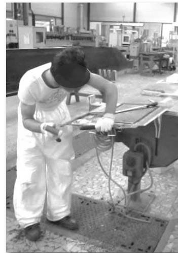
Figure 23 : Déconstruction avec marteau et ciseau
