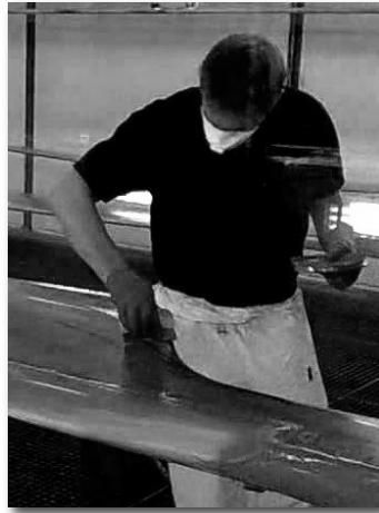
Figure 25 : Imprégnation du mastic bleu
