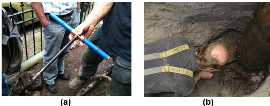
Figure II-45. Carottier (a) et prélèvement d'échantillon à l'aide du carottier (b)
