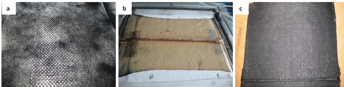
Figure 39 : a) Mise en place de noir de carbone entre les couches ; b) Injection de la résine en infusion ; c) Plaque imprégnée
