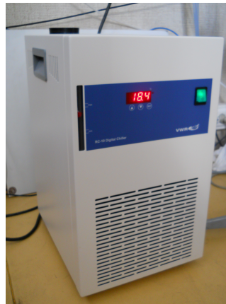
Figure 2.10: Système de refroidissement mis en place pour la source d'ions : le circulateur RC-10 Digital Chiller.
