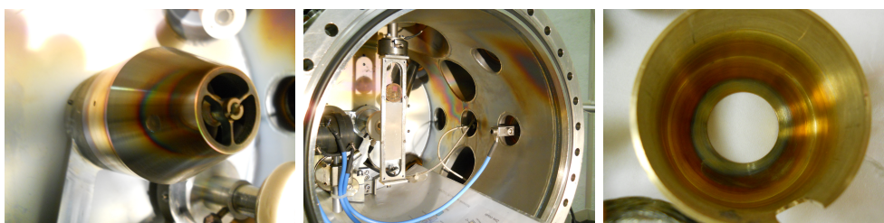
Figure 2.20: La pollution de la chambre d'analyse (à gauche sur le collimateur, au centre sur la paroi de la chambre d'analyse) et le collimateur conçu et mis en place sur la lentille afin d'empêcher ces dégradations (à droite).
