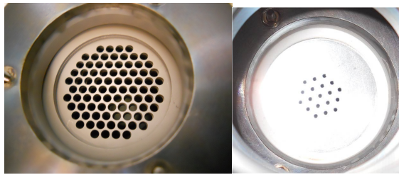
Figure 2.16: Grilles d'extraction standards (gauche) et adaptées au faisceau deutérium (droite)
