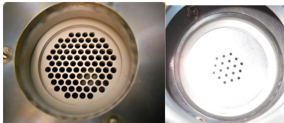
Figure 2.16: Grilles d'extraction standards (gauche) et adaptées au faisceau deutérium (droite)
