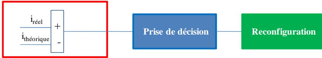
**Figure I-12 :** Concept général de la surveillance d'embarquement
