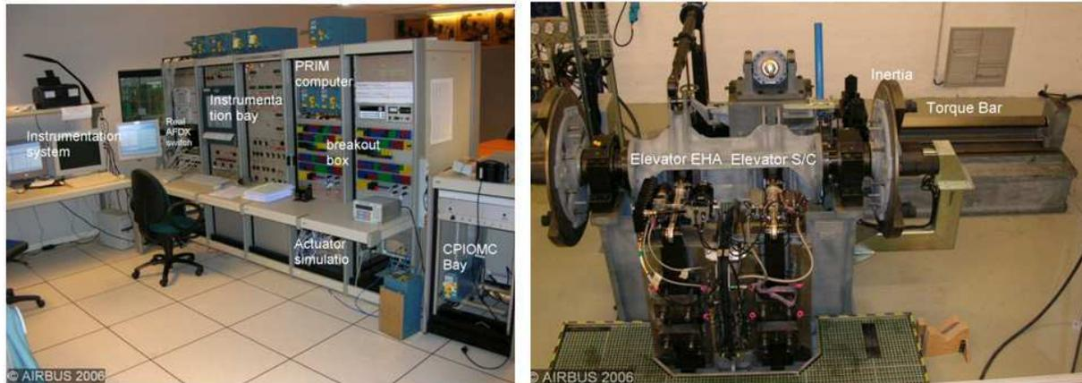
**Figure IV-8 :** Banc Intégration Système couplé au Banc Actionneur
