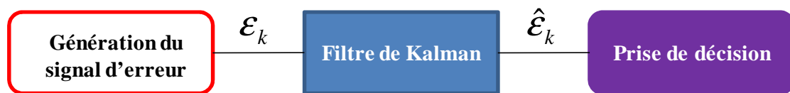
Figure II-2 : Introduction d'un filtre de Kalman dans la chaîne de surveillance
